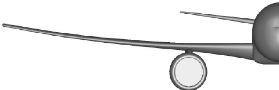
Σχήμα 3: Πρόσοψη της συμμετρικής γεωμετρίας του μοντέλου CRM (Common Research Model) της NASA στη διαμόρφωση που περιλαμβάνει οριζόντιο ουραίο και κινητήρα. [12]
