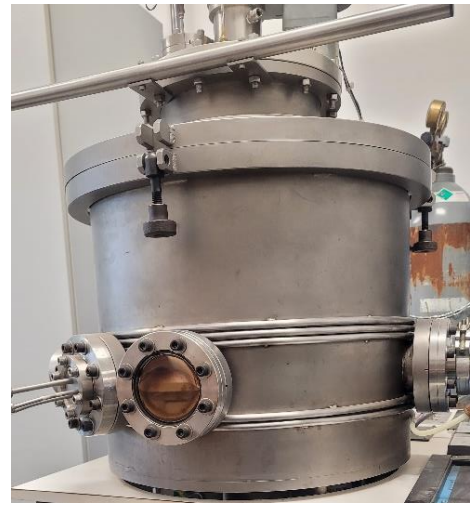
Εικόνα 2.3: Θάλαμος που εκτελείται το sputtering στο εργαστήριο του INN.
