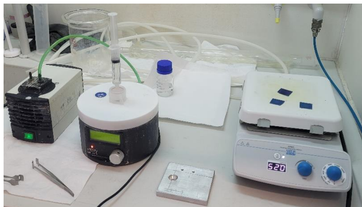
Εικόνα 2.1: Πειραματική διάταξη και οργανολογία φυγοκέντρισης (spin coating) με την αντλία, το φυγοκεντριστή KLM spin coater, τη θερμαινόμενη πλάκα, τα υποστρώματα και το διάλυμα E – gel.
