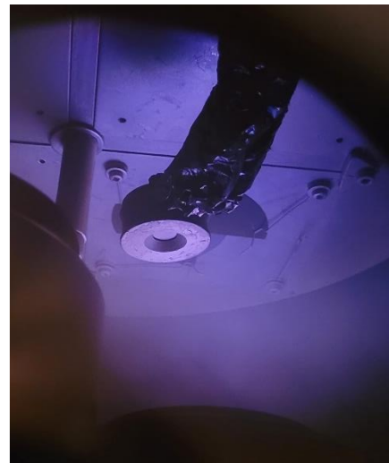
Εικόνα 2.6: Απεικόνιση κρυστάλλου quartz μέσα στο σύστημα του sputtering κατά τη διεργασία εναπόθεσης στο εργαστήριο του INN.
