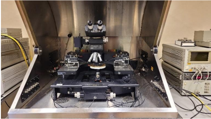
Εικόνα 3.7: Διάταξη που χρησιμοποιήθηκε για το χαρακτηρισμό των πυκνωτών. Περιλαμβάνει το κλωβό Faraday, μικροσκόπιο, σύστημα ακίδων (probes), βάση στήριξης (vacuum chuck), BNC coaxial καλώδια, LCR meter HP4284A, αμπερόμετρο HP 4140B.
