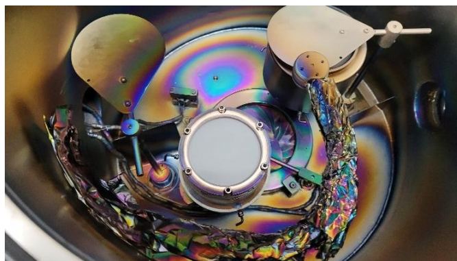
Εικόνα 2.2: Εσωτερική απεικόνιση του συστήματος sputtering με τους στόχους.
