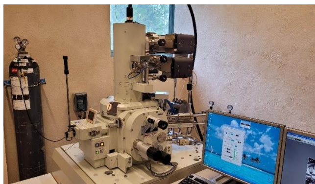
Εικόνα 3.5: Σύστημα FE – SEM της JOEL, JSM – 7401F στο εργαστήριο του INN.
