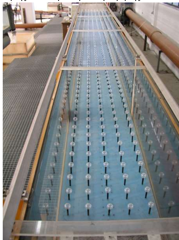
Εικόνα 4.7. Πανοραμική όψη παράλληλης διάταξης για την περίπτωση της σύνθετης άκαμπτης βλάστησης
