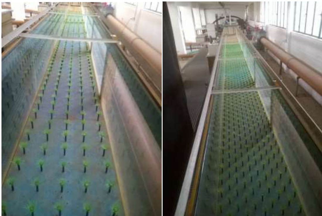
Εικόνα 4.5. Πανοραμική όψη διατάξεων για την περίπτωση της σύνθετης ημι-εύκαμπτης βλάστησης: (α) παράλληλη διάταξη και (β) κλιμακωτή διάταξη
