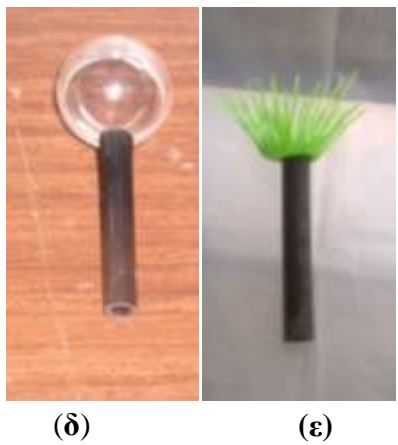
Εικόνα 4.2. Στοιχεία βλάστησης σε σειρά: α) απλή ράβδος, β) σύνθετη άκαμπτη, γ) σύνθετη ημι-εύκαμπτη (τα δ,ε είναι φωτογραφίες των σύνθετων στοιχείων)
