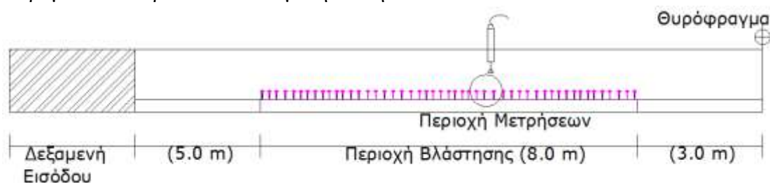
Εικόνα 4.1. Σκαρίφημα μηκοτομής του καναλιού
