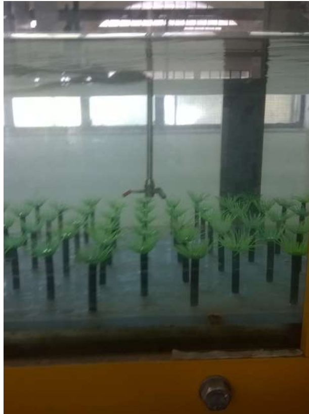
Εικόνα 4.6. Πλευρική όψη κλιμακωτής διάταξης για την περίπτωση της σύνθετης ημι-εύκαμπτης βλάστησης κατά την διάρκεια μέτρησης
