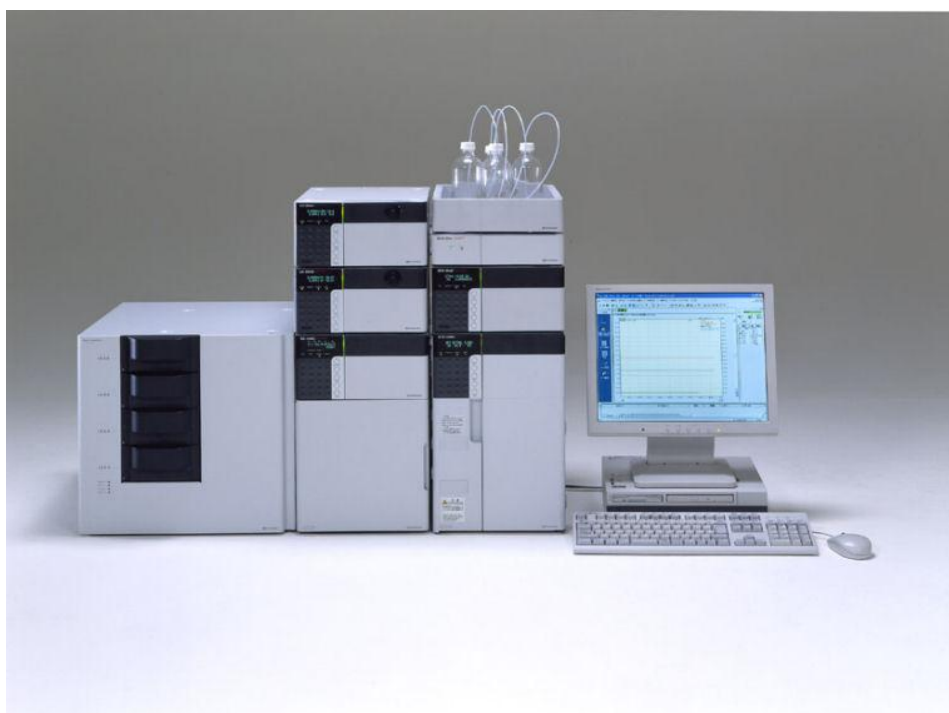
Εικόνα 10:Υγρός χρωματογράφος υψηλής πίεσης (HPLC) Shimadzu
