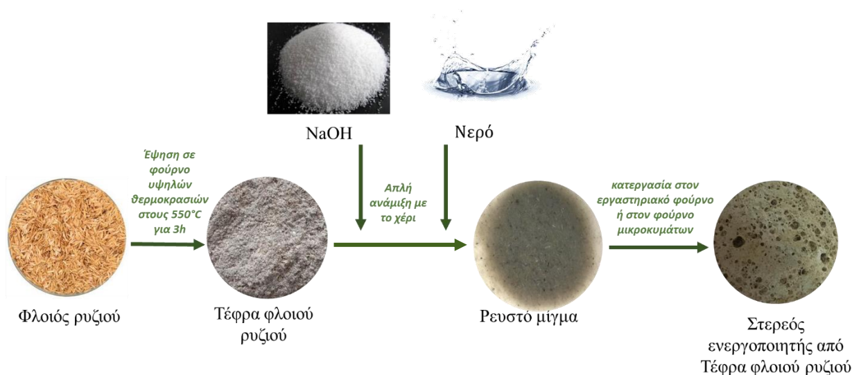
Σχήμα 19. Στάδια σύνθεσης παραγωγής στερεού ενεργοποιητή από τέφρα φλοιού ρυζιού
