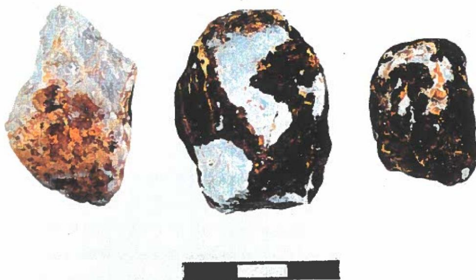
Φωτογραφία 7-4: Επικαθήσεις που σχηματίζονται πάνω στην επιφάνεια των χαλικιών ασβεστολίθου παρουσία Fe^{3+}
