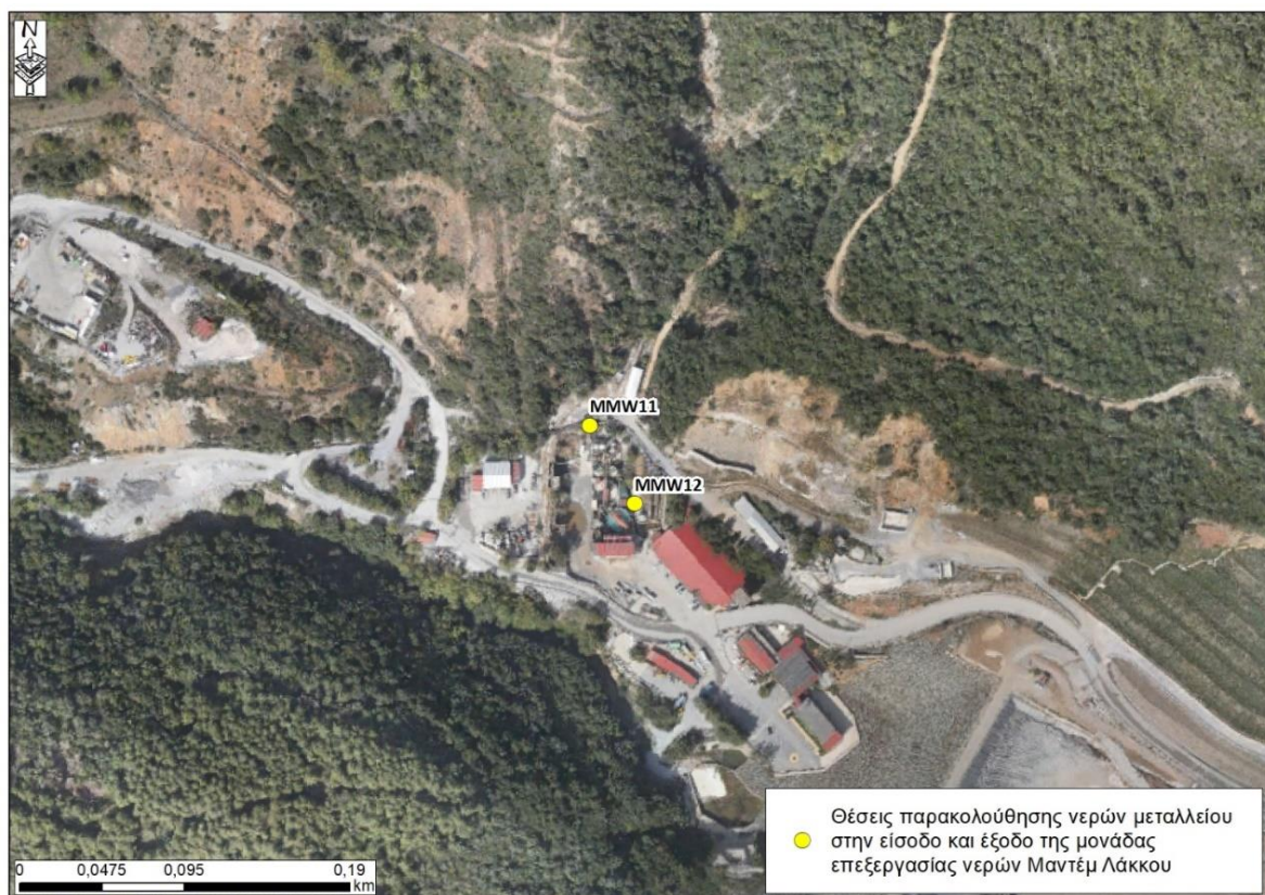
Σχήμα 5-9: Θέσεις παρακολούθησης των νερών μεταλλείου Μαύρων Πετρών στην είσοδο και στην έξοδο του υφιστάμενου συστήματος κατεργασίας
