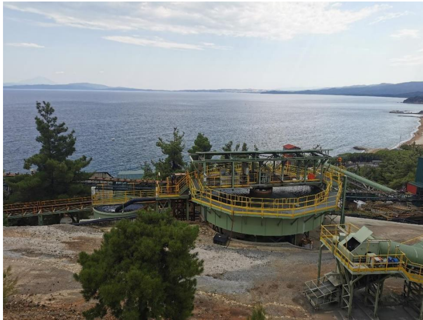
Φωτογραφία 5-12: Κύριος Πυκνωτής διαχωρισμού στερεών/υγρών
