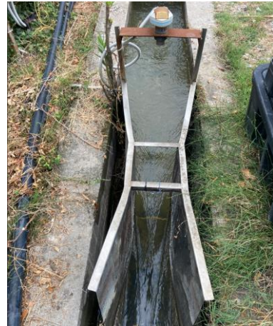
Αισθητήρα υπερήχων μέτρησης της παροχής για ανοιχτό κανάλι (μέθοδος venturi) στην τελική απορροή των λιμνών διαύγασης (PROBE LR SIEMENS)
