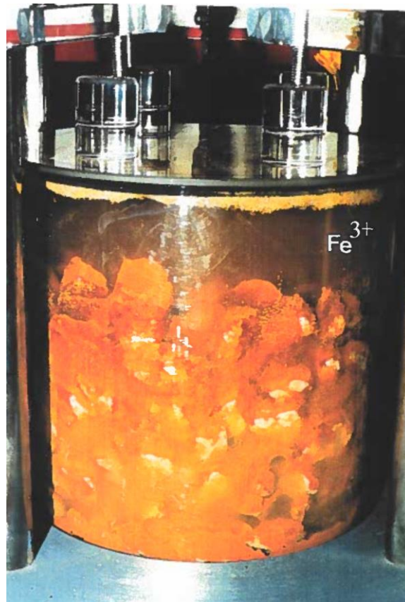
Φωτογραφία 7-3: Ιλύς υδροξειδίων του τρισθενούς σιδήρου που σχηματίζεται εντός κελιών ALDs
