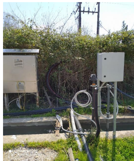
Αισθητήρες μέτρησης pH (pHD sc HACH LANGE) & αγωγιμότητας (3700 HACH LANGE) στην τελική απορροή των λιμνών διαύγασης
