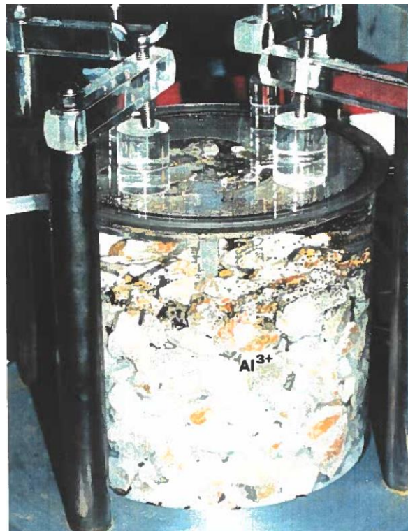
Φωτογραφία 7-6: Ιζήματα αλουμινίου που σχηματίστηκαν μέσα στην πειραματική συσκευή ALD
