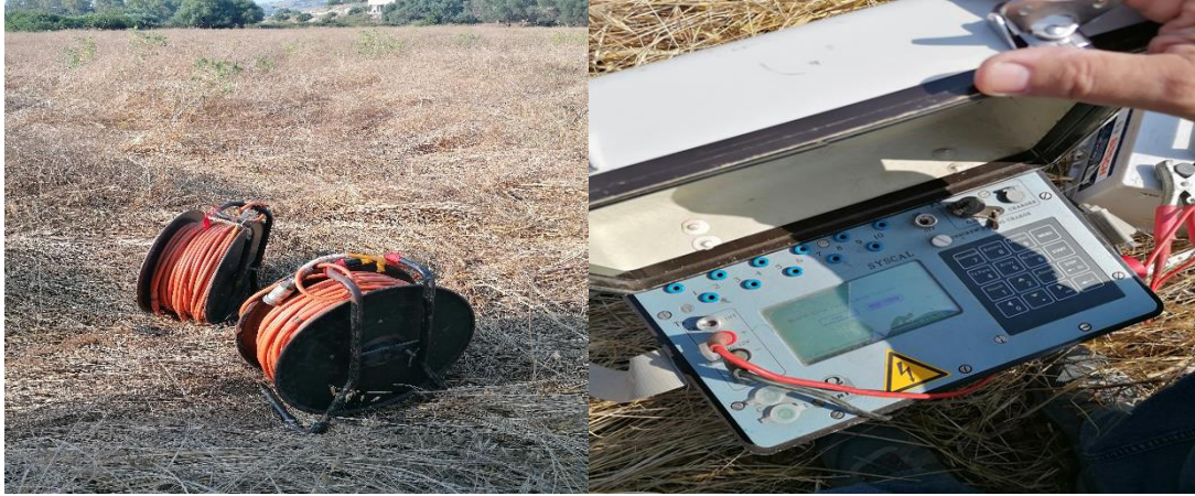
Εικόνα 36: Τα καλώδια με καρούλια που συνδέθηκαν με το SYSCAL PRO στις γεωφυσικές έρευνες στο Λιβάδι Κεφαλληνίας & SYSCAL PRO (Εργαστήριο Εφαρμοσμένης Γεωφυσικής-Σχολή Μεταλλειολόγων Μεταλλουργών Μηχανικών ΕΜΠ)
