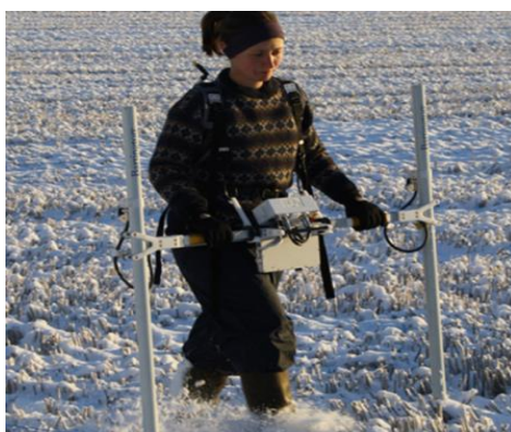
Εικόνα 10: Κάθετη διάταξη πηνίων στον ίδιο άξονα στο EM34-XL
