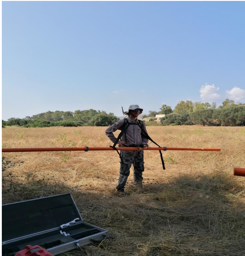
Εικόνα 97: Ηλεκτρομαγνητικές μετρήσεις με τη χρήση οργάνου CMD-4 σε βάθος διασκόπησης 6m , στη θέση Λιβάδι
