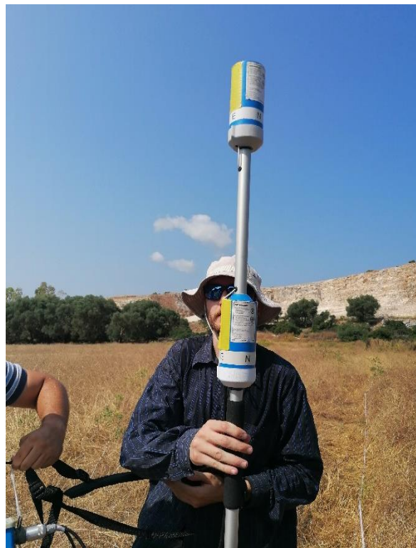
Εικόνα 25: Τα δύο πηνία του πρωτονικού μαγνητόμετρου που μετράνε σε δύο διαφορετικά ύψη το ολικό πεδίο και δείχνουν κατά την μέτρηση συνεχώς προς τον Βορρά
