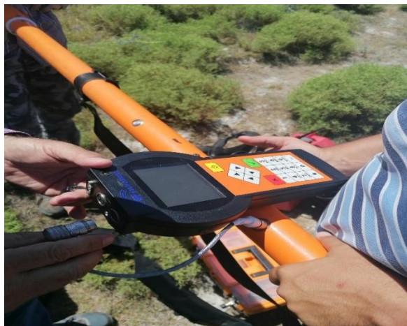
Εικόνα 7: Χειριστήριο ρυθμίσεων και ελέγχου μετρήσεων του CMD που χρησιμοποιήθηκε στις γεωφυσικές έρευνες στο Λιβάδι, Κεφαλληνίας
