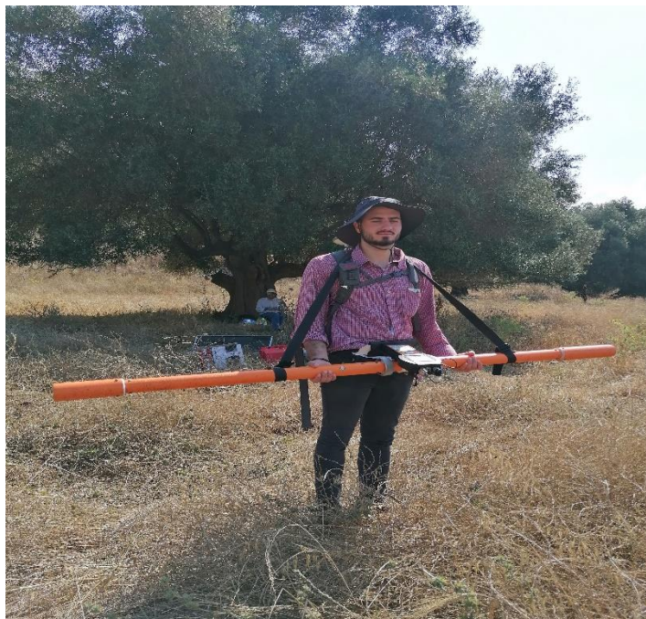
Εικόνα 98: Ηλεκτρομαγνητικές μετρήσεις με τη χρήση οργάνου CMD-2 σε βάθος διασκόπησης 3 m , στη θέση Λιβάδι
