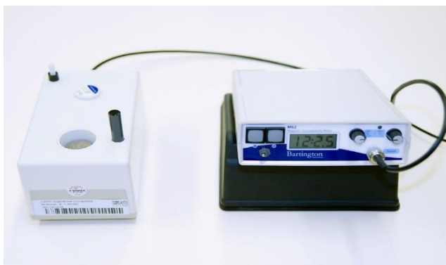
Εικόνα 12: BartingtonMS2D διάταξη μέτρησης της μαγνητικής επιδεκτικότητας
