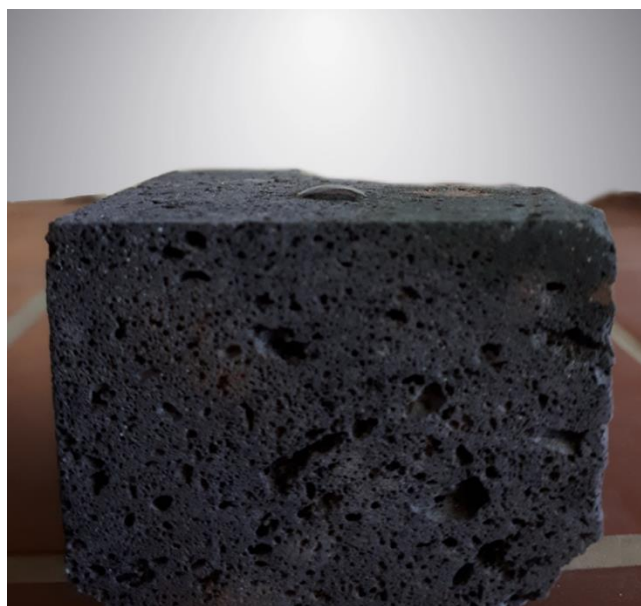
Εικόνα 81. Μακροσκοπική απεικόνιση του δείγματος 9 που φέρει σταγόνα νερού στην επιφάνειά του, ένδειξη της υδροφοβικότητάς του.
