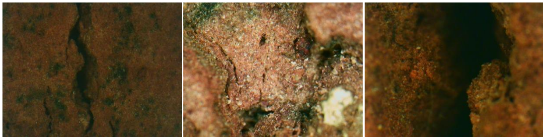
Εικόνα 26. Δείγμα 14. Ρωγμή, πόρος και αδρανή (30x, 50x, 120x)
