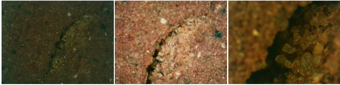
Εικόνα 28. Δείγμα 16. Βαθύς πόρος επάνω, ρωγμή με πολλά αδρανή, κάτω (30x, 50x, 120x)
