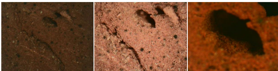
Εικόνα 13. Δείγμα 1. Ρωγμή και πόροι (30x, 50x, 120x).
