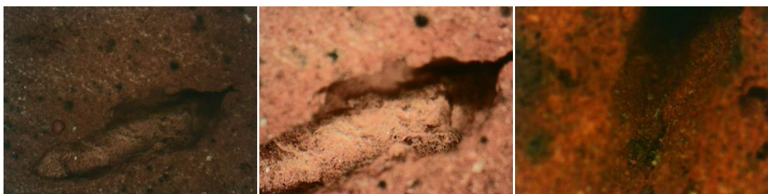
Εικόνα 18. Δείγμα 6. Πόρος (30x, 50x, 120x)
