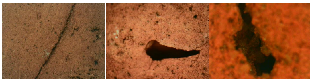
Εικόνα 15. Δείγμα 3. Ρωγμή και πόροι (30x, 50x, 120x)
