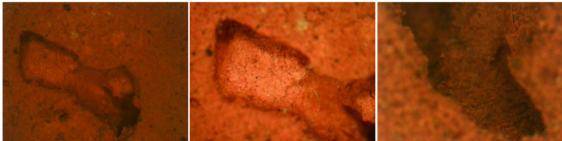
Εικόνα 32. Δείγμα 20. Πόρος (30x, 50x, 120x)
