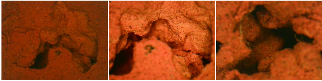
Εικόνα 31. Δείγμα 19. Πόρος (30x, 50x, 120x)
