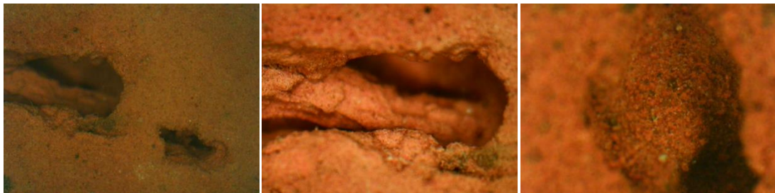
Εικόνα 24. Δείγμα 12. Πόροι (30x, 50x, 120x)
