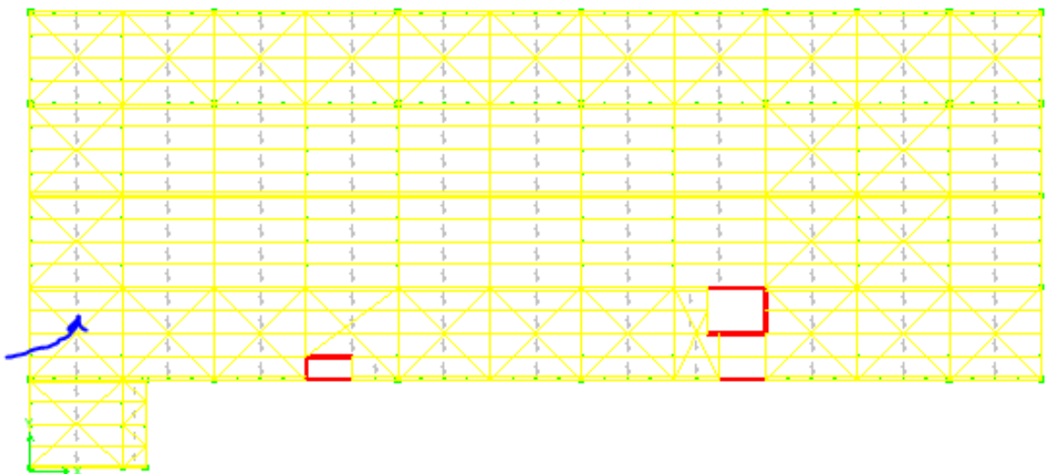
Σχήμα 4.10 Ακριβής θέση της τεγίδας
