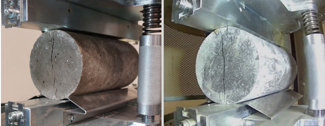
Σχήμα 3.17: Δοκίμιο CC (αριστερά) και GC (δεξιά) μετά τη δοκιμή διάρρηξης.
