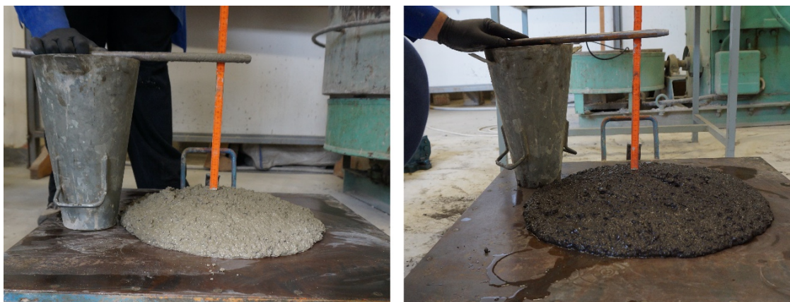
Σχήμα 3.13: Σκυρόδεμα CC (αριστερά) και GC (δεξιά) κατά τη δοκιμή της κάθισης.
