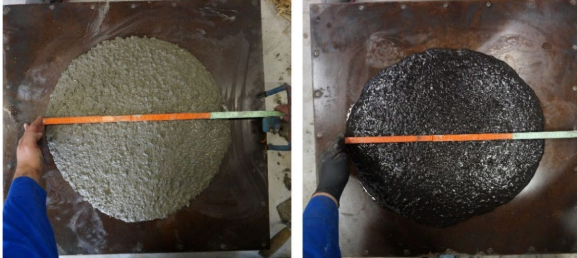
Σχήμα 3.12: Σκυρόδεμα CC (αριστερά) και GC (δεξιά) κατά τη δοκιμή μέτρησης του μέτρου εξάπλωσης.
