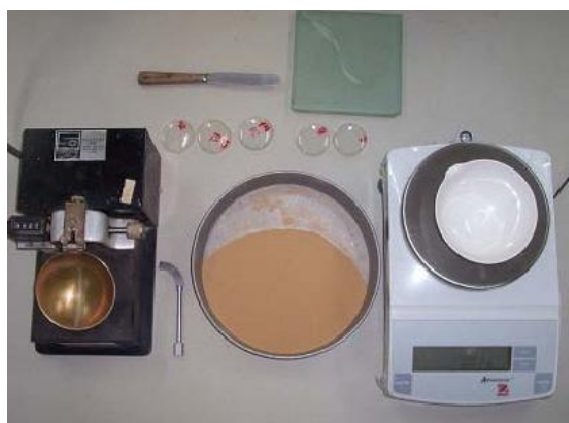
Εικόνα 6.3. Εξοπλισμός δοκιμής Cassagrande για προσδιορισμό του w_L
