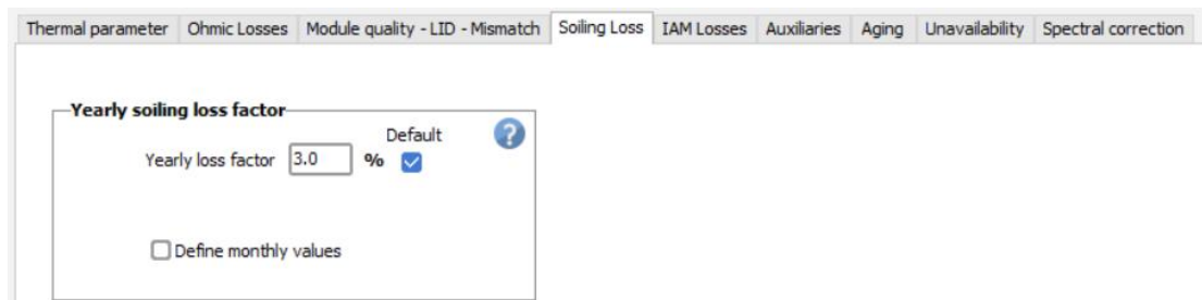
Εικόνα 4-48: Απώλειες λόγω σκονισμένων επιφανειών
