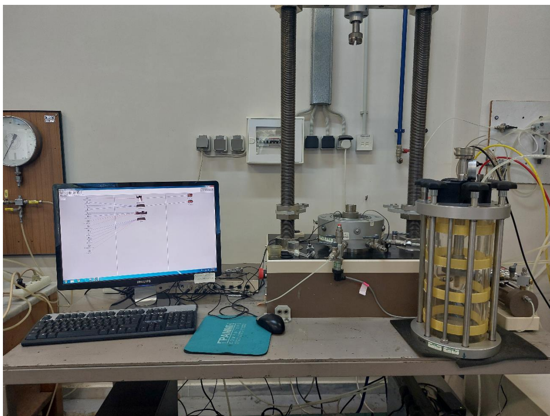
Σχήμα 3.10: Τριαξονική δυναμική συσκευή (Bishop & Wesley, 1975) του εργαστηρίου Εδαφομηχανικής ΕΜΠ
