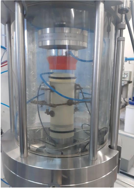
Σχήμα 4.13: Φωτογραφίες δοκιμίου άμμου M31: α) πριν την φόρτιση, β) μετά από τριαξονική, ανακυκλική φόρτιση υπό εμποδιζόμενη στράγγιση
