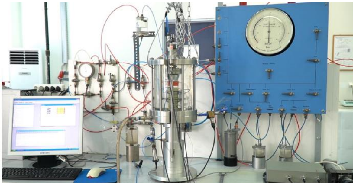
Σχήμα 3.7: Τριαξονική συσκευή (Bishop & Wesley, 1975) του εργαστηρίου Εδαφομηχανικής ΕΜΠ
