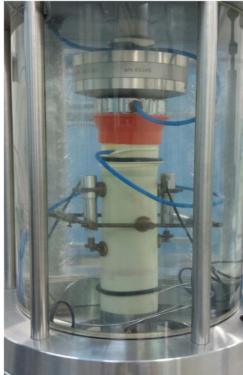
Σχήμα 3.6: Τυπική διάταξη κυλινδρικής τριαξονικής συσκευής
