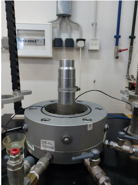
Σχήμα 3.11: Καλούπι κατασκευής του δοκιμίου φυσικής άμμου
