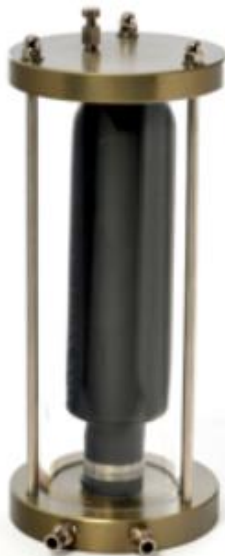
Σχήμα 3.9: Τυπική διάταξη κυλινδρικής τριαξονικής συσκευής
