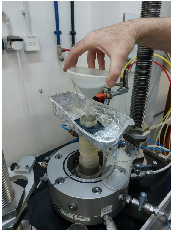
Σχήμα 3.12 Διαδικασία τοποθέτησης της φυσικής άμμου στο καλούπι
