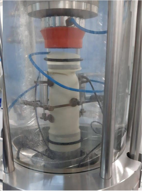
Σχήμα 4.13: Φωτογραφίες δοκιμίου άμμου M31: α) πριν την φόρτιση, β) μετά από τριαξονική, ανακυκλική φόρτιση υπό εμποδιζόμενη στράγγιση
