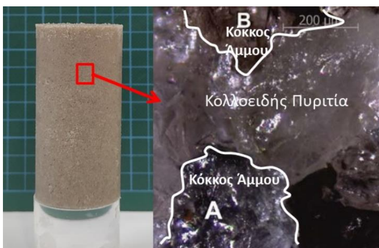
Σχήμα 3.13: Σταθεροποιημένο δοκίμιο άμμου M31 φωτογραφία και απεικόνιση ηλεκτρονικό μικροσκόπιο
