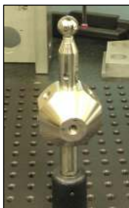
Σχήμα 1: Διαμορφώσεις, προεκτάσεις, ακίδες, πρότυπη σφαίρα, Ιδιοσυσκευές
