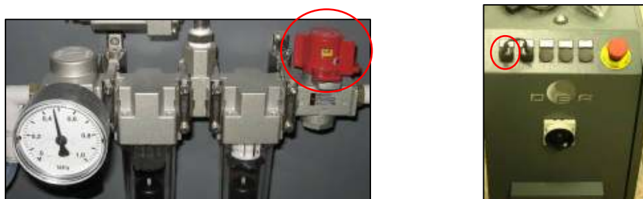
Σχήμα 4: Διακόπτης παροχής αέρα & διακόπτης On/Off
