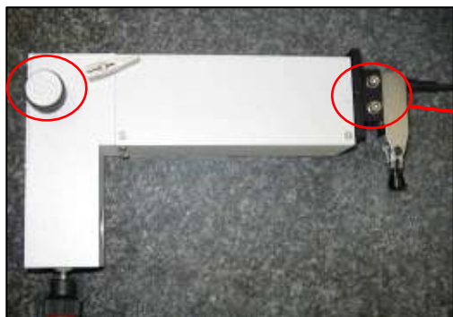
Σχήμα 17: Έλεγχος ευθυγράμμισης βοηθητικών χαραγών
