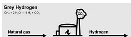
Εικόνα 7 Σχεδιάγραμμα και βασική εξίσωση παραγωγής γκρι υδρογόνου
