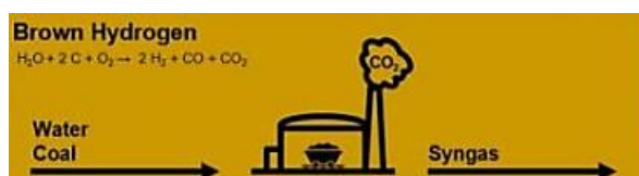
Εικόνα 8 Σχεδιάγραμμα και βασική εξίσωση παραγωγής καφέ υδρογόνου
