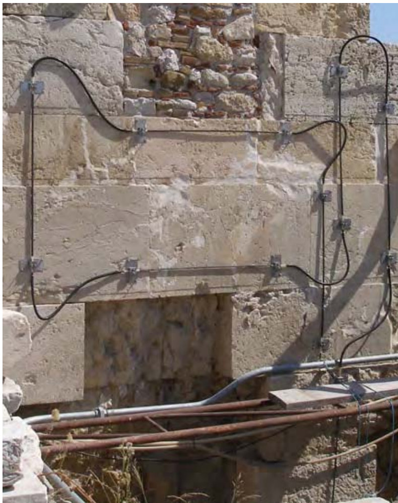
Σχ. 3.1: Τυπική Διάταξη Οπτικής Ίνας επί του Β. Τείχους της Ακροπόλεως
