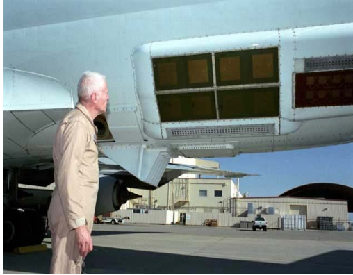
Σχ. 4.4: Radar Συνθετικού Ανοίγματος πάνω σε αεροπλάνο
