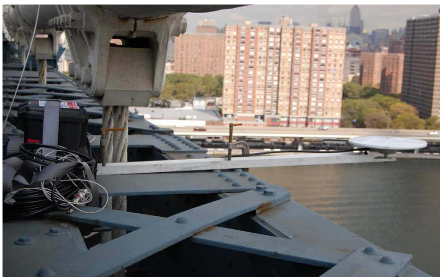
Σχ. 3.5: Δέκτης GPS τοποθετημένος στην Γέφυρα του Μανχάταν
