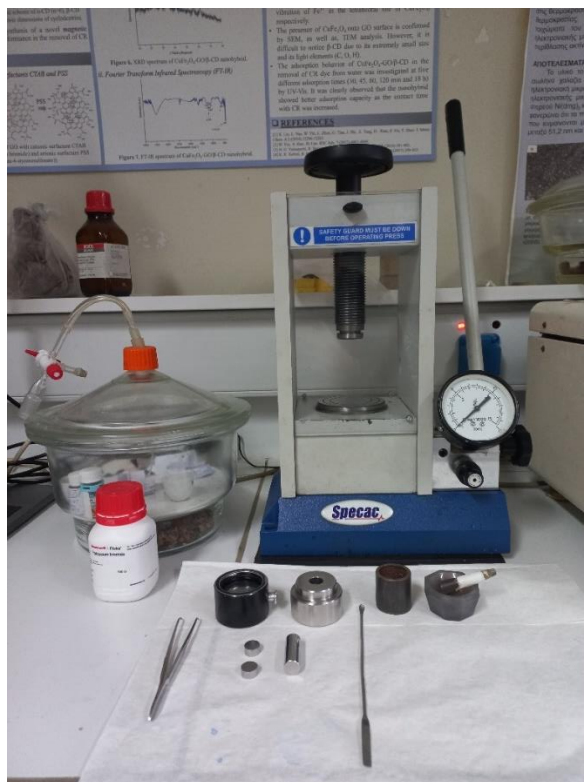
Εικόνα 16: Η διάταξη της πρέσας και τα σύνεργα που χρησιμοποιήθηκαν για την παρασκευή των δισκίων.
