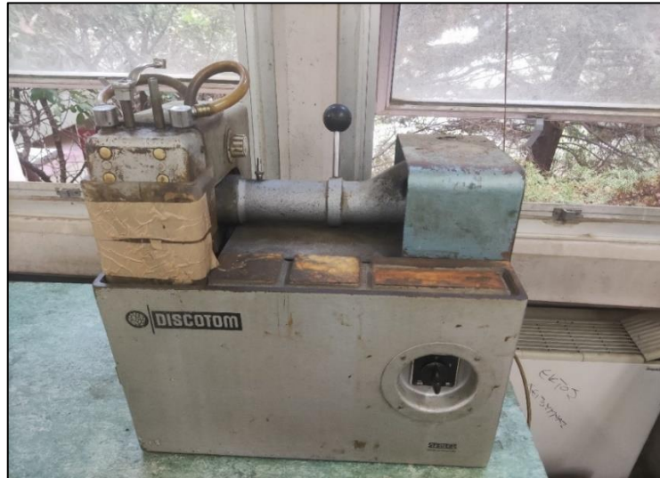
Εικόνα 2.3: Δισκοτόμος Struers (εργαστήριο μεταλλογνωσίας)
