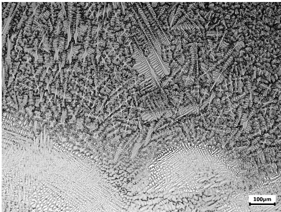
Εικόνα 3.5: Μικρογραφία οπτικού μικροσκοπίου της ΖΤ του δοκιμίου 70.1 (μεγέθυνση 100X)
