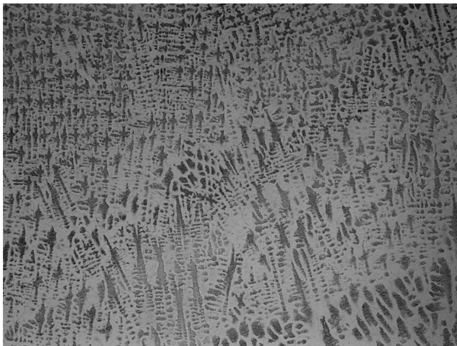
Εικόνα 3.13: Μικρογραφία οπτικού μικροσκοπίου της ΖΤ του δοκιμίου 80.1 (μεγέθυνση 200X)
