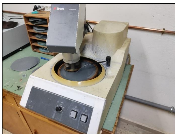
Εικόνα 2.5: Μηχάνημα οριζόντιου, υδρόψυκτου, μονοαξονικού περιστρεφόμενου δίσκου λείανσης μάρκας Struers (εργαστήριο μεταλλογνωσίας)
