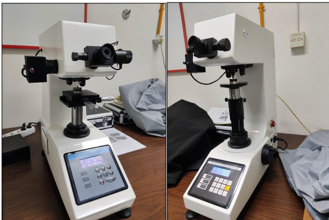
Εικόνα 2.13: Το μικροσκληρόμετρο HV-1000Z (εργαστήριο μεταλλογνωσίας) (αριστερά), Το σκληρόμετρο SCTMC HV-50Z (εργαστήριο μεταλλογνωσίας) (δεξιά)
