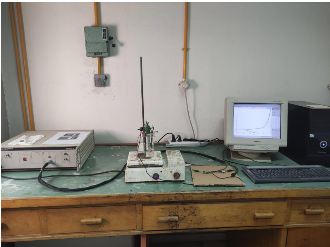
Εικόνα 39: Ποτενσιοστάτης, ηλεκτροχημικό κελί και λογισμικό καταγραφής του ρεύματος. Εξωτερικά της διάταξης, μέρος του συστήματος αποτελεί και ο ποτενσιοστάτης (Εικόνα 39), με τη βοήθεια του οποίου καταγράφεται η διαφορά δυναμικού ανάμεσα στην άνοδο και
