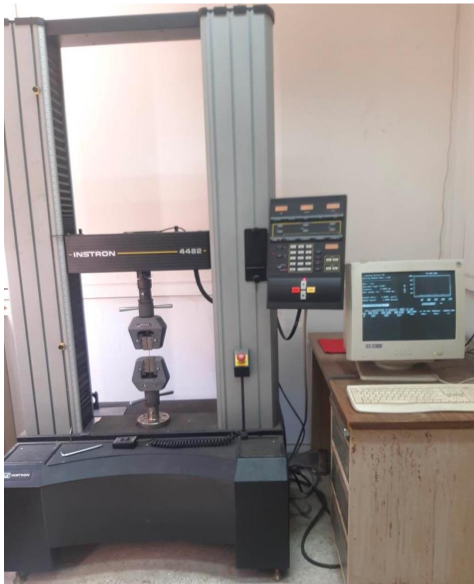
Εικόνα 34: Πειραματική διάταξη της μηχανής εφελκυσμού που χρησιμοποιήθηκε για της μετρήσεις εφελκυστικής αντοχής
