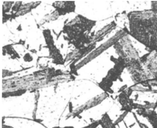
Εικόνα 22: Μικρογραφία ανώτερου μπαϊνίτη (σκούρο χρώμος,) μερικώς μετασχηματισμένος στους 460°C, [14]
