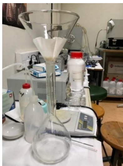
Σχήμα 6.2: Διήθηση ρητίνης μετά την ανάδευση της σε απιονισμένο νερό.
