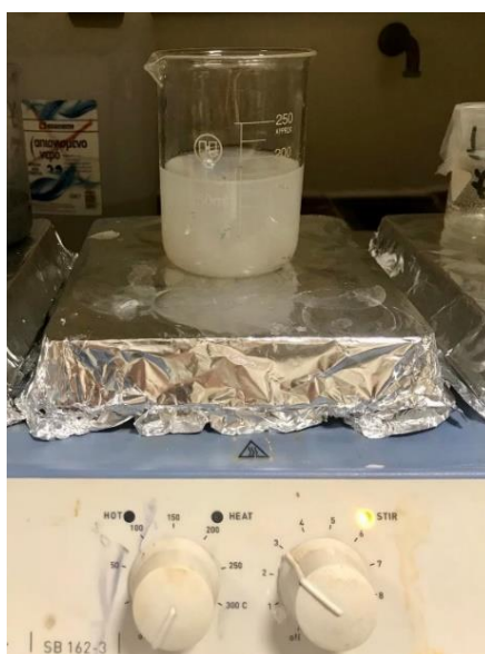
Σχήμα 6.3: Ανάδευση ρητίνης με μεθανόλη με σκοπό την ενεργοποίησή της.
