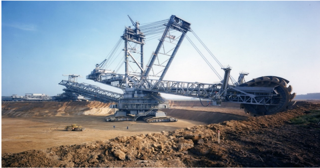
Εικόνα 13: Καδοφόρος Εκσκαφέας ( https://wall.alphacoders.com/ )
