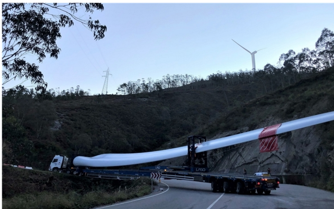
Εικόνα 10: Μεταφορά με ανυψωμένο πτερύγιο για αιολική εγκατάσταση ( www.iefimerida.gr )
