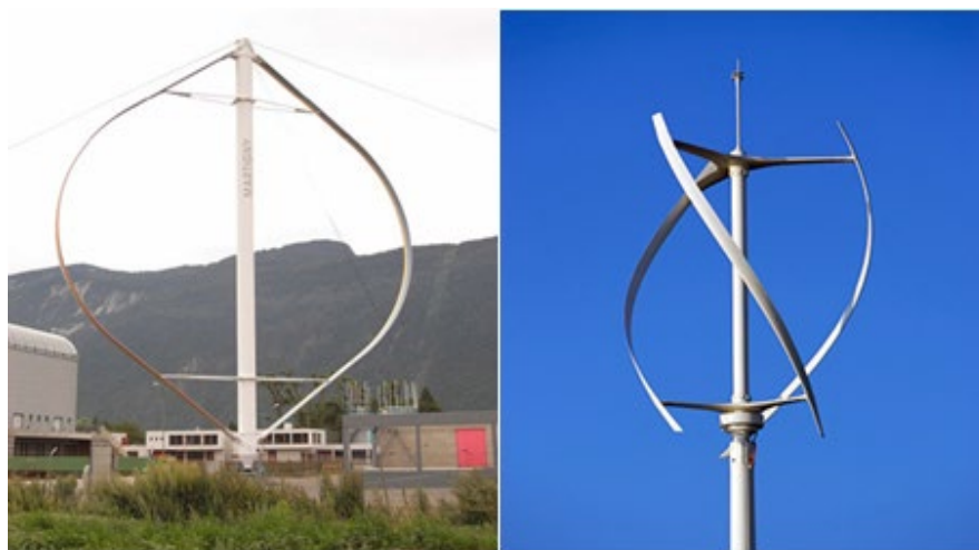
Εικόνα 4: Ανεμογεννήτριες VAWT Darrieus κλασική και ελικοειδής αντίστοιχα (Kamran, M. 2022)
