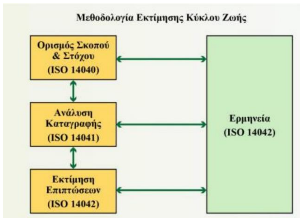
Σχήμα 3.2: Μεθοδολογικό πλαίσιο ανάλυσης κύκλου ζωής[3.5]
