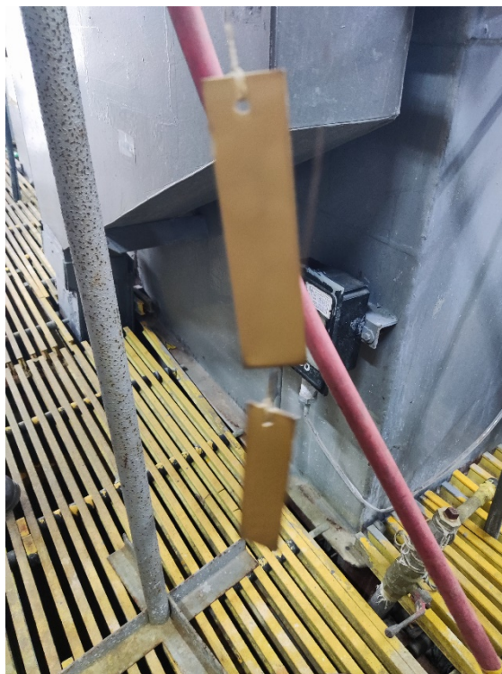
Εικόνα 7: Εξωτερική εμφάνιση των δοκιμίων επικαδμίσωσης μετά το πέρας της χρωμικής μετατροπής
