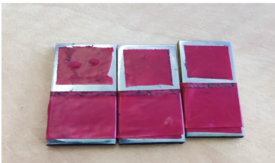
Εικόνα 8: Εικόνα των δοκιμίων που προορίζονται για επιμετάλλωση Zn-Ni πριν την μόνωση της εξωτερικής επιφάνειας
