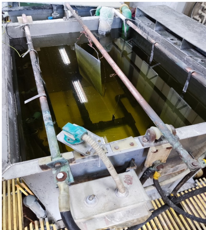
Εικόνα 5: Εισαγωγή των δοκιμίων επικαδμίωσης εντός του λουτρού επικαδμίωσης
