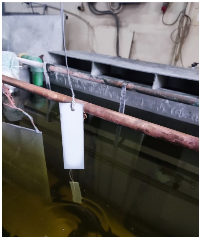
Εικόνα 6: Εξωτερική εμφάνιση των δοκιμών επικαδμίωσης αμέσως μετά το πέρας της επιμετάλλωσης
