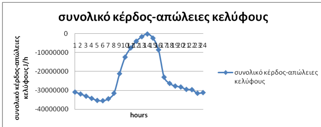
Σχήμα 60:συνολικές απώλειες κελύφους για την 21 η Ιανουαρίου για κτήριο αναφοράς της Αθήνας.
