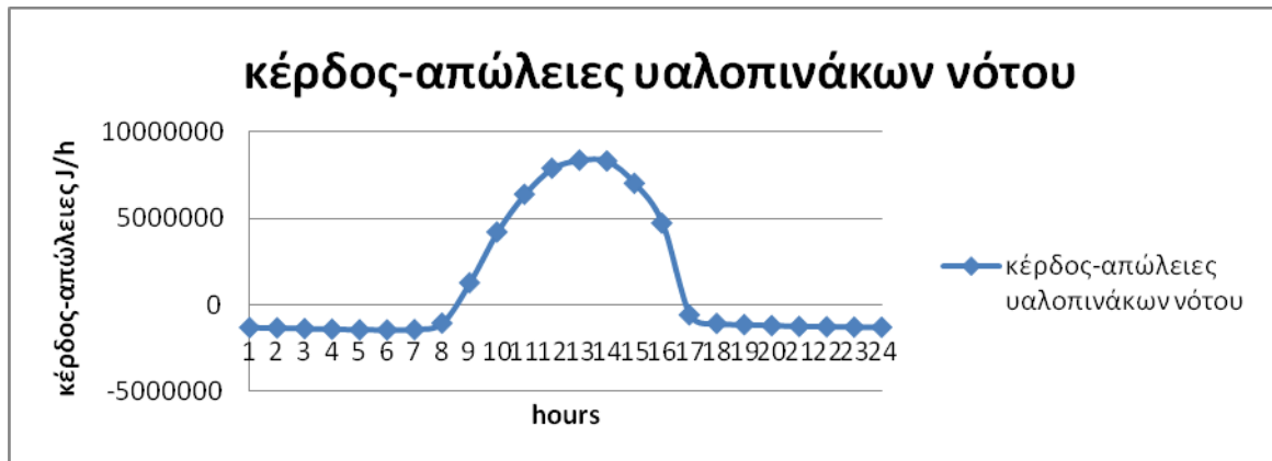
Σχήμα 52: κέρδος-απώλειες υαλοπινάκων νότου.
