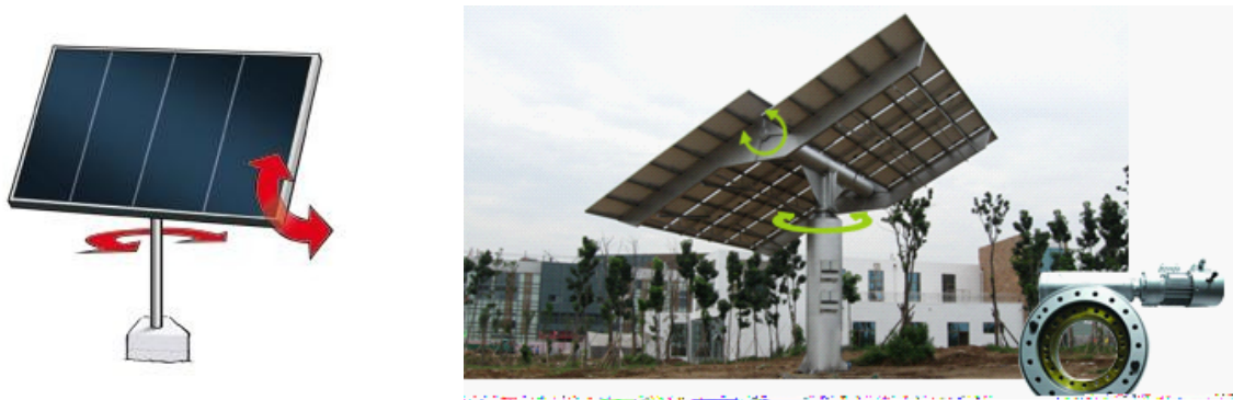
Εικόνα 3.12. Περιστροφή συστήματος γύρω από δύο άξονες (Πηγή: www.google.gr & www.helapco.gr )
