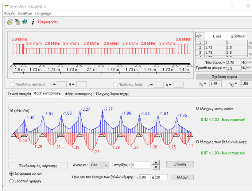
Εικόνα 4.3: Έλεγχος σύμμικτης πλάκας στη φάση κατασκευής.
