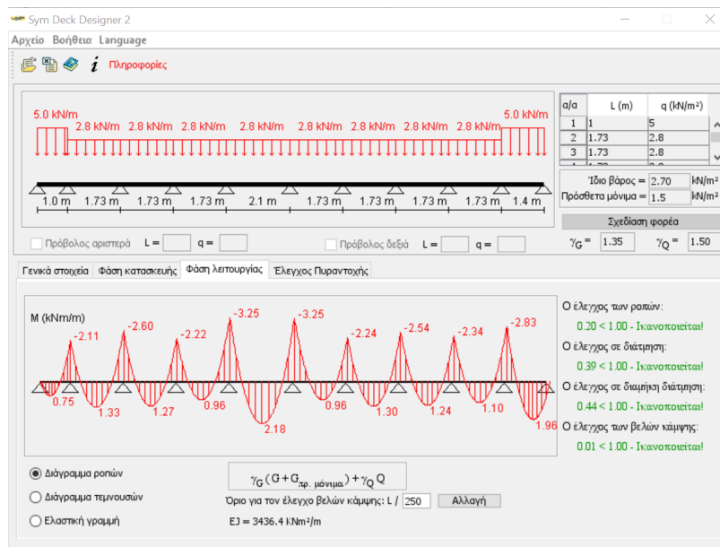
Εικόνα 4.4: Έλεγχος σύμμικτης πλάκας στη φάση λειτουργίας.
