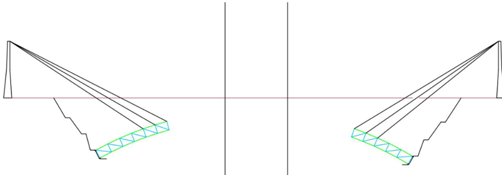
Εικόνα 7.1 1 η Φάση ανέγερσης τόξου
