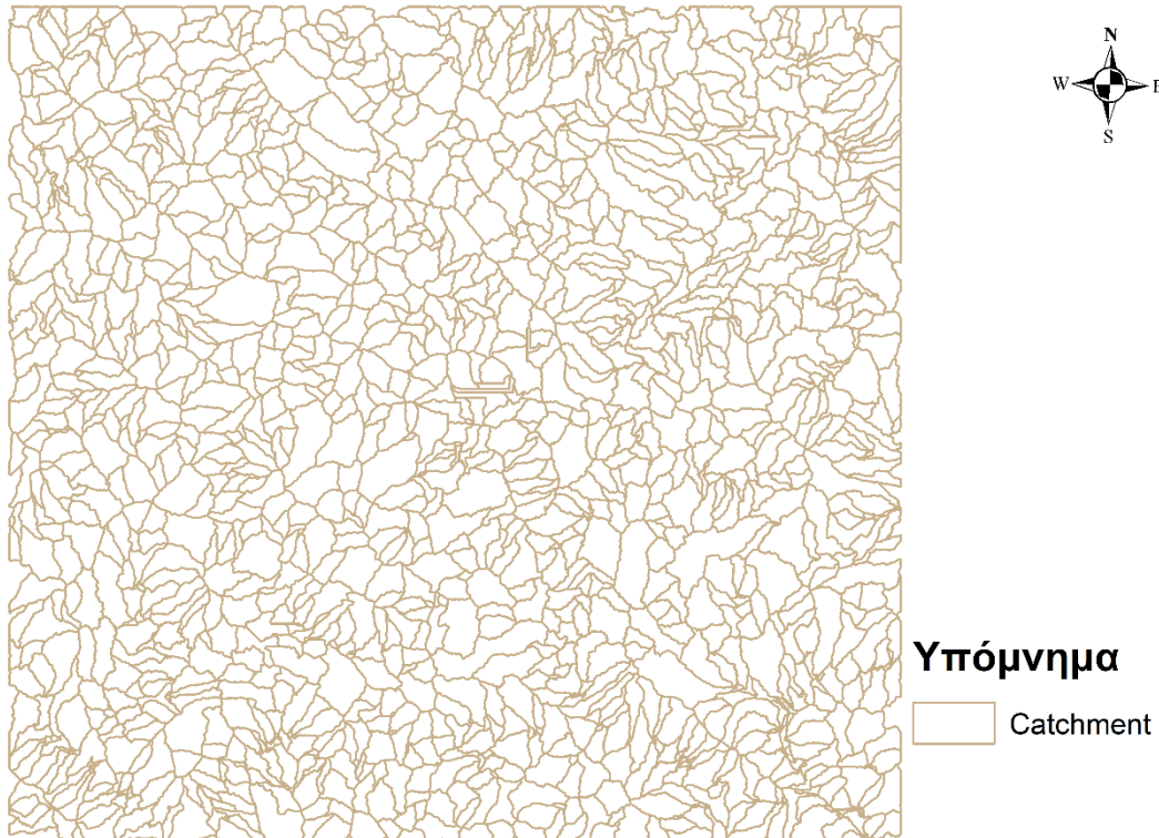
Εικόνα 3.19: Μετατροπή υπολεκανών σε διανυσματική μορφή
