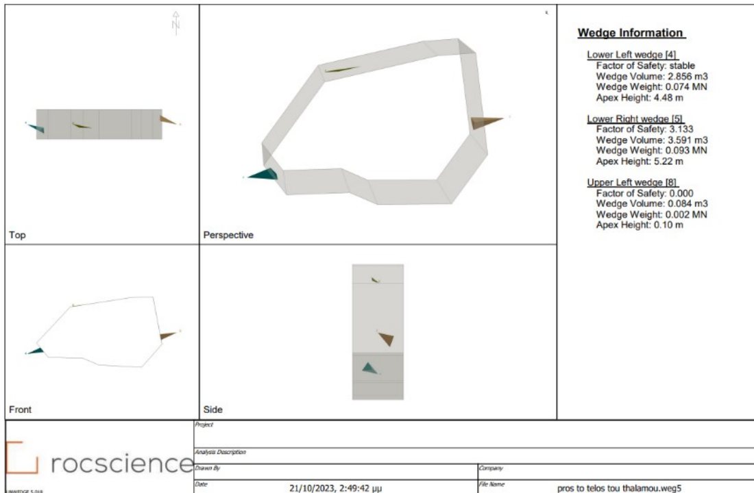
Σχήμα 6-3: Τρισδιάστατη προβολή σφηνών στη θέση 1 με persistence 6m
