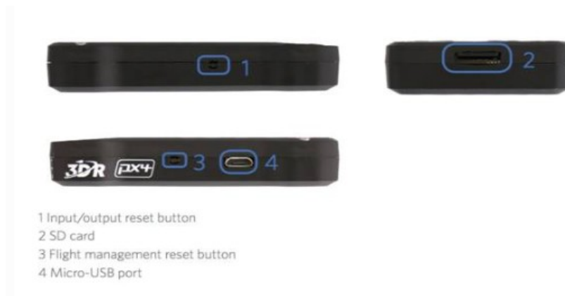
Εικόνα 25 (β). το σύστημα αυτόματου ελέγχου Pixhawk cube και οι διαθέσιμες θύρες.
