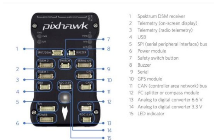
Εικόνα 25 (α). το σύστημα αυτόματου ελέγχου Pixhawk cube και οι διαθέσιμες θύρες.
