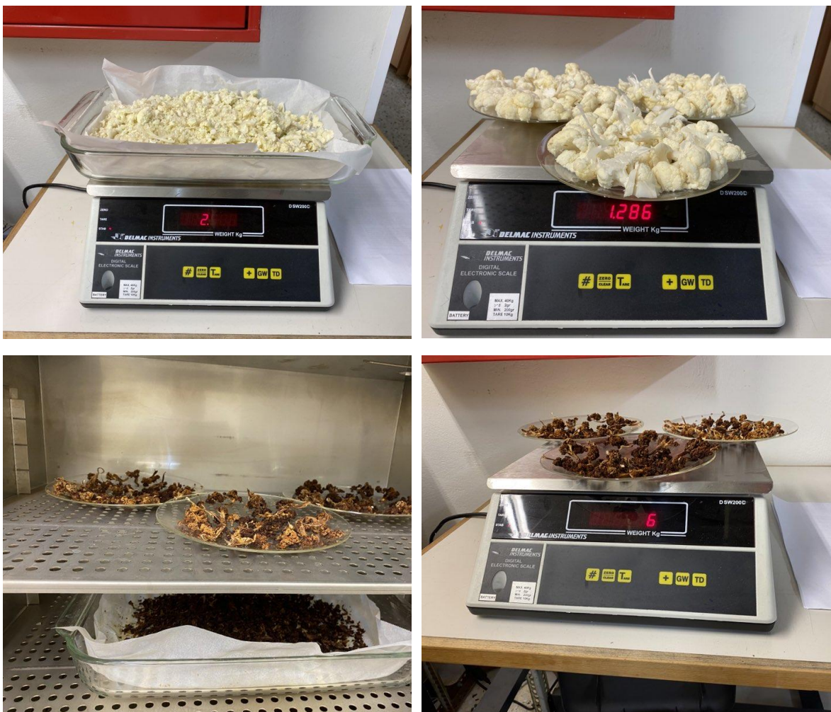
Εικόνα 18: Πάνω αριστερά και δεξιά: Ζύγιση δείγματος σε σκεύος και σε δίσκους. Κάτω αριστερά: Αποξήρανση δείγματος. Κάτω δεξιά: Ζύγιση ξηρής μάζας κουνουπιδιού.
