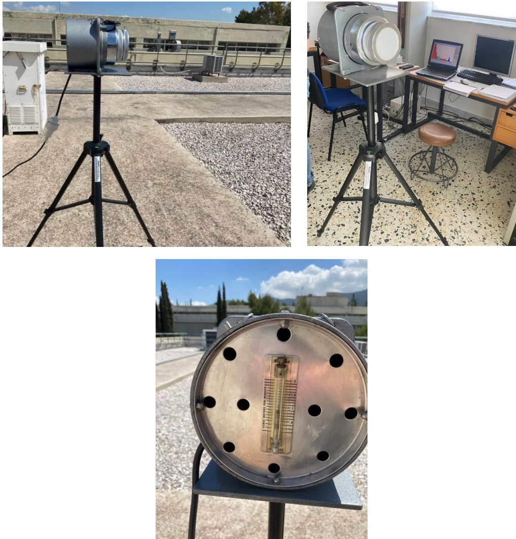
Εικόνα 25: Αριστερά: Φορητός δειγματολήπτης αέρα του Εργαστηρίου Πυρηνικής Τεχνολογίας. Δεξιά: Φίλτρο αέρα \varnothing 4'' , προσαρμοσμένο στην αντλία. Κάτω: Ένδειξη παροχής αέρα σε \text{m}^3/\text{min} .
