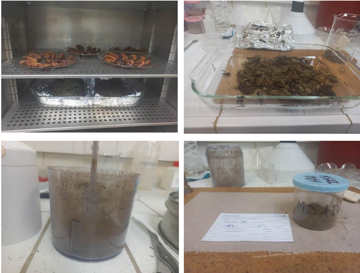
Εικόνα 8: Πάνω αριστερά: Μαρούλι και μήλο μετά τη ξήρανση. Πάνω δεξιά: Θρυμματισμός μαρουλιού με πλύση. Κάτω αριστερά: Ομογενοποίηση του πλυμένου μαρουλιού σε μπλέντερ. Κάτω δεξιά: Καταγραφή δεδομένων, κυπελάκι γεωμετρίας 8.
