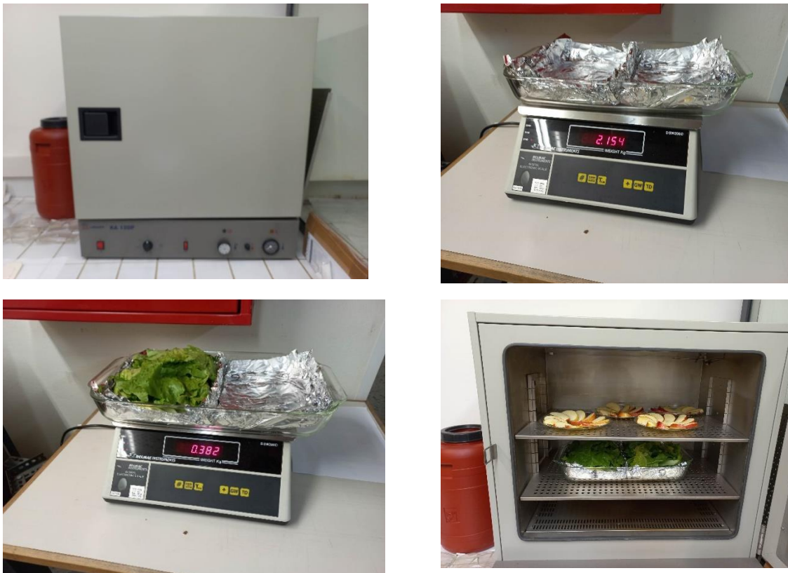
Εικόνα 7: Πάνω αριστερά: Φούρνος ξήρανσης. Πάνω δεξιά: Ζύγιση σκεύους. Κάτω αριστερά: Ζύγιση μαρουλιού μετά την πλύση. Κάτω δεξιά: Ξήρανση μαρουλιού και μήλου.
