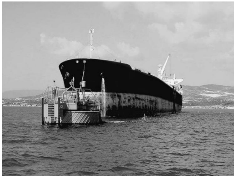
Εικόνα (3): Πλοίο εφοδιασμένο με σύστημα παραγωγής, αποθήκευσης και εκφόρτωσης πετρελαίου (FPSO) αγκυρωμένο με συνδιασμό ανωστικού σώματος και αλυσσιδών γραμμών αγκύρωσης [18].
