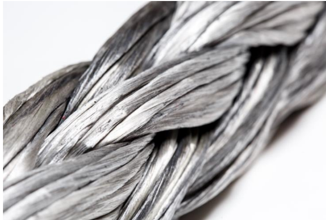
Εικόνα (10): Συρματόσχοινο από HMPE [23].
