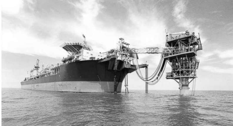
Εικόνα (2): Πλοίο εφοδιασμένο με σύστημα παραγωγής, αποθήκευσης και εκφόρτωσης πετρελαίου (FPSO) αγκυρωμένο με σύστημα ενός σημείου με σταθερό πύργο [18].
