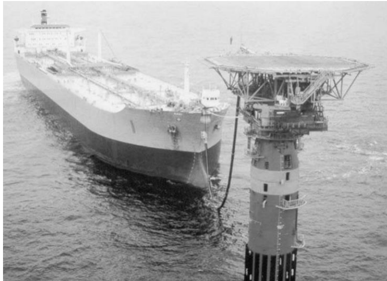
Εικόνα (6): Πλοίο αγκυρωμένο μέσω συστήματος ALP και έτοιμο για την φόρτωση πετρελαίου [18].
