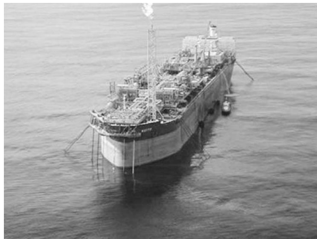
Εικόνα (1): Πλοίο εφοδιασμένο με σύστημα παραγωγής, αποθήκευσης και εκφόρτωσης πετρελαίου (FPSO) αγκυρωμένο με σύστημα πολλαπλών κλάδων [18].
