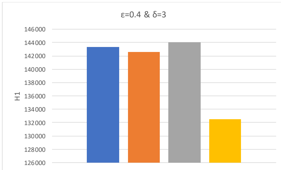
Διάγραμμα (3): Οριζόντια δύναμη H_1 για w_2=15 kg/m, N=6 , \varepsilon=0.4 & \delta=3 (μπλε: D=20 , πορτοκαλί: D=50 , γκρι: D=100 , κίτρινο: D=300 ).
