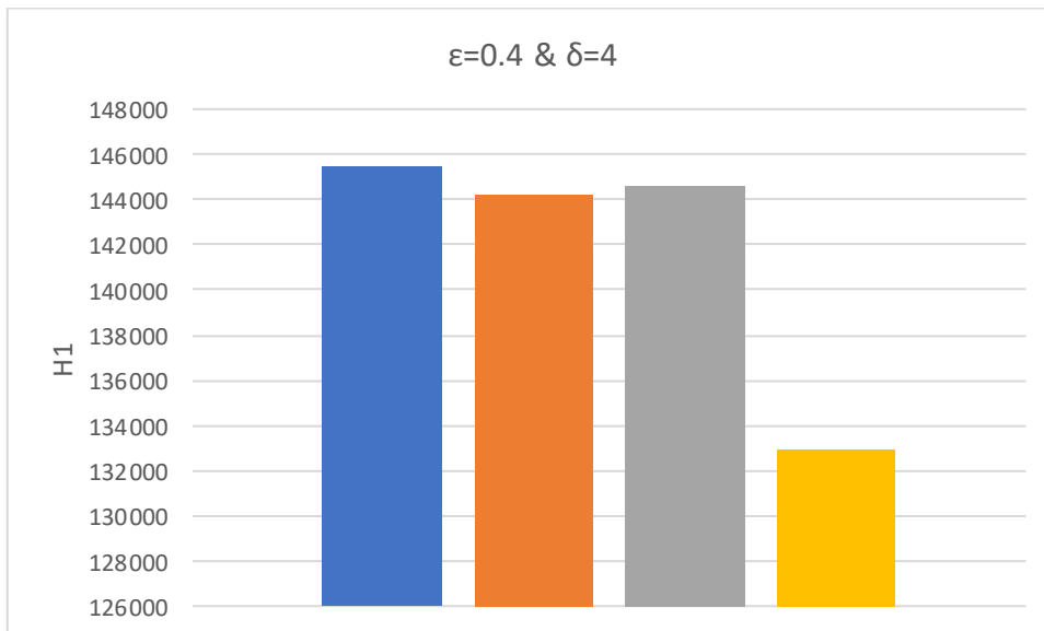
Διάγραμμα (6): Οριζόντια δύναμη H_1 για w_2=15 \text{ kg/m} , N=6 , \epsilon=0.4 & \delta=4 (μπλε: D=20 , πορτοκαλί: D=50 , γκρι: D=100 , κίτρινο: D=300 ).
