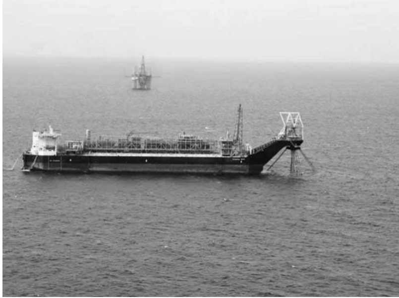
Εικόνα (4): Πλοίο εφοδιασμένο με σύστημα παραγωγής, αποθήκευσης και εκφόρτωσης πετρελαίου (FPSO) αγκυρωμένο μέσω εξωτερικού πυργίσκου [18].
