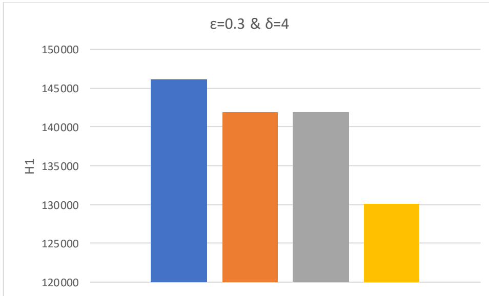
Διάγραμμα (5): Οριζόντια δύναμη H_1 για w_2=15 \text{ kg/m} , N=6 , \epsilon=0.3 & \delta=4 (μπλε: D=20 , πορτοκαλί: D=50 , γκρι: D=100 , κίτρινο: D=300 ).
