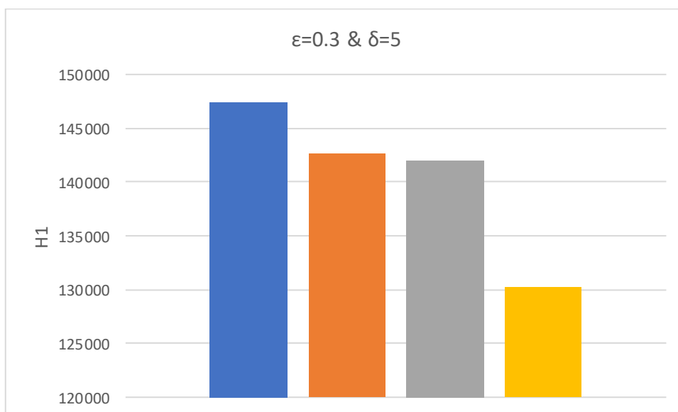
Διάγραμμα (8): Οριζόντια δύναμη H1 για w_2=15 \text{ kg/m} , N=6 , \epsilon=0.3 & \delta=5 (μπλε: D=20 , πορτοκαλί: D=50 , γκρι: D=100 , κίτρινο: D=300 ).
