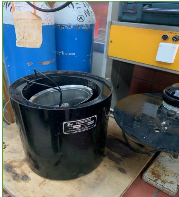
Εικόνα 16: Θερμιδόμετρου βόμβας οξυγόνου, μοντέλο 1341 της εταιρείας Parr Instrument Company
