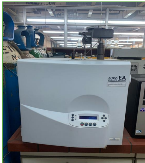
Εικόνα 19: Στοιχειακός αναλυτής EURO ELEMENTAL ANALYZER 3000 της εταιρείας EuroVector S.p.A.
