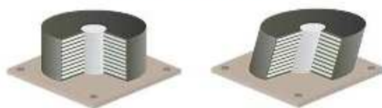
Εικόνα 3.2 Ελαστομεταλλικό εφέδρανο με πυρήνα μολύβδου.
