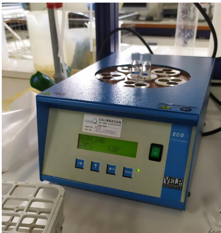
Εικόνα 3.4.1.2. Συσκευή χώνευσης για μέτρηση COD (mg/l).
