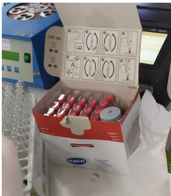
Εικόνα 3.4.1.4. Αντιδραστήρια που χρησιμοποιήθηκαν για τη μέτρηση του Fe^{2+} .
