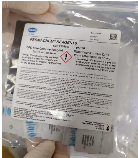
Εικόνα 3.4.3.2. Αντιδραστήρια που χρησιμοποιήθηκαν για την εύρεση υπολειμματικού χλωρίου.
