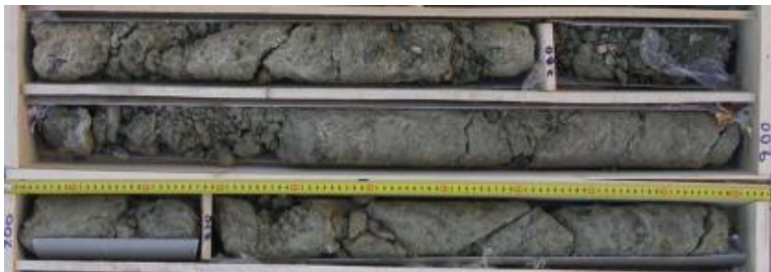
Εικόνα 92 Μέτρια διαταραγμένοι μεταψαμμίτες με GSI: 45-55 (Γ:HH2243).
