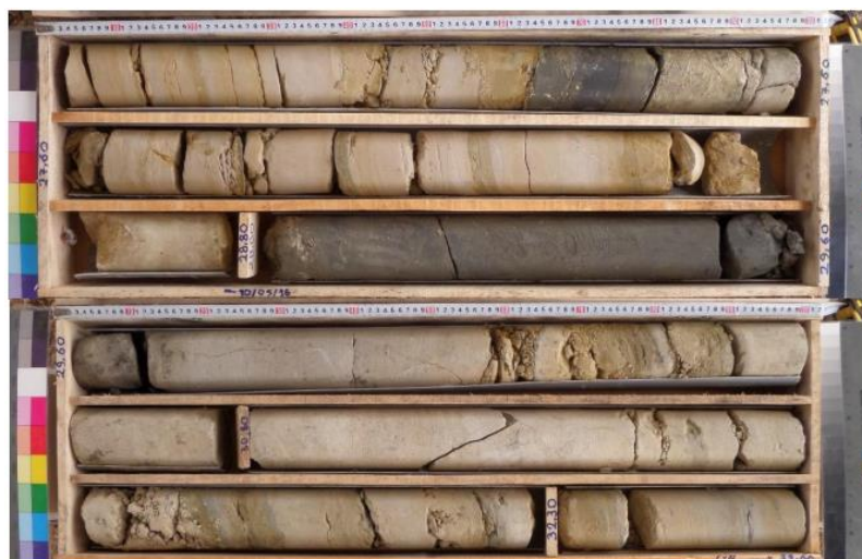
Εικόνα 50 Ανοιχτοκίτρινη μάργα με παρεμβολές γκρίζου ιλυόλιθου. Δειγματοληπτική γεώτρηση ενδιάμεσα των σταθμών «Ανθούπολη» και «Ίλιον». (Boronkay et al., 2021)
