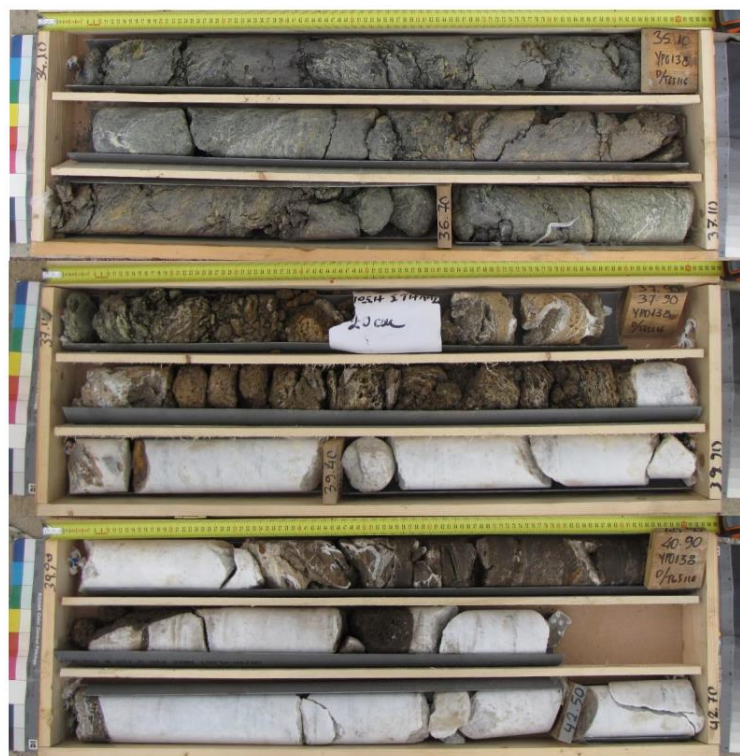
Εικόνα 49 Γκριζοπράσινος, αποσαθρωμένος σερπεντινίτης (34,1 - 37,30) και λευκό, καρστικό, κρυσταλλικό, δολομιτικό (;) μάρμαρο. Τα καρστικά κενά ήταν γεμάτα με καστανότεφρο σιδηρούχο, ανθρακικό λατυποπαγές. Γεώτρηση από μελλοντική επέκταση της γραμμής 4 προς Βύρωνα και Ηλιούπολη. (Boronkay et al., 2021)
