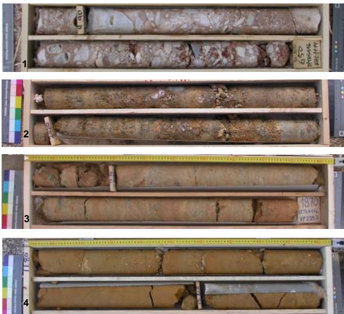
Εικόνα 82 Χαρακτηρισμός σχηματισμών κατά ISRM (1981).1) MS – μετρίως ισχυρό (κροκαλοπαγές Γ:HP114 βάθος:4.90-6.50), 2) MW – μετρίως ασθενής (ψαμμίτης Γ:CP1703 βάθος:28.70-30.50), 3) W – ασθενής (κλαστικός σχηματισμός Γ:HP2257 βάθος:17.10-18.70), 4) VW – εξαιρετικά ασθενής (αργιλόλιθος Γ:HH2249 βάθος:11.80-13.20).
