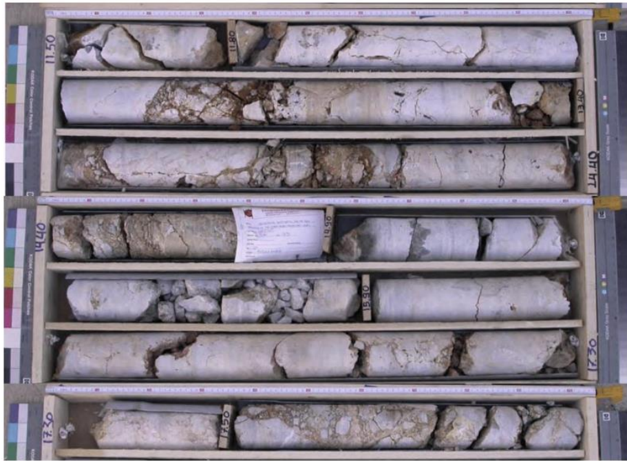
Εικόνα 45 Συμπαγής, καρστικός, τοπικά ενδοκλαστικός (17,50 – 17,85 m) Ασβεστόλιθος Κορυφής. Γεώτρηση από υπό κατασκευή Γραμμή 4, ενδιάμεσα των σταθμών «Γαλάτσι» και «Ελικώνος». (Boronkay et al., 2021)
