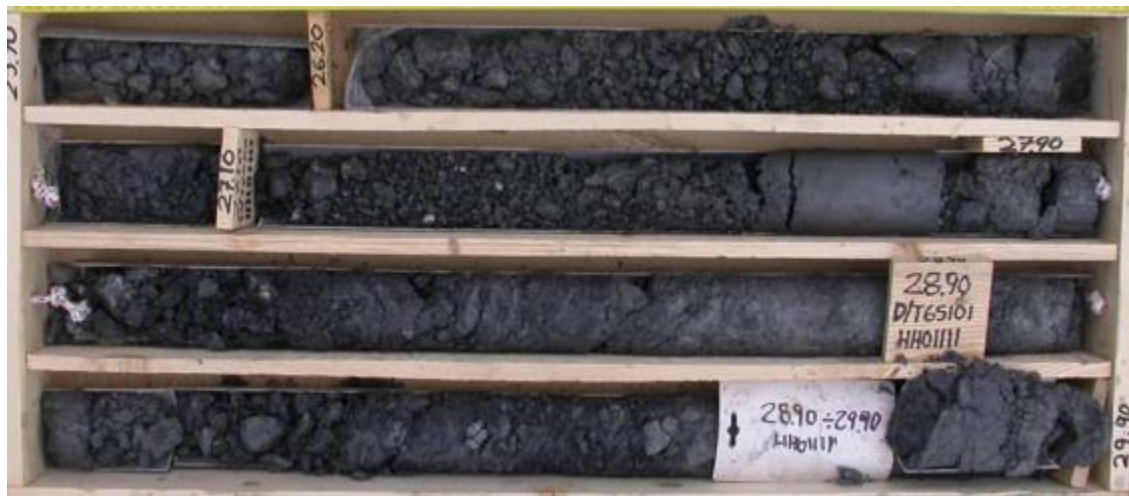
Εικόνα 95 Έντονα τεκτονικά παραμορφωμένη μεταίλυολιθική βραχομάζα με GSI: 15-25 (Γ:HP1111).
