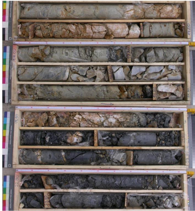
Εικόνα 43 Επαφή του μετα – ιλυόλιθου με φακούς χαλαζία (Ανώτερου Αθηναϊκού Σχιστόλιθου) με σκούρο κυανότεφρο ιλυόλιθο (Κατώτερου Αθηναϊκού Σχιστόλιθου) σε γεώτρηση της υπό κατασκευή Γραμμής 4 του Μετρό, μεταξύ των σταθμών «Δικαστήρια» και «Αλεξάνδρας». (Boropkay et al., 2021)
