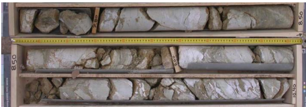
Εικόνα 85 Πολύ κερματισμένος μαργακός ασβεστόλιθος με GSI: 50-60 (Γ:HH2207).
