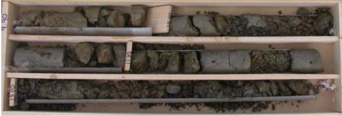
Εικόνα 93 Αποδιοργανωμένος ή αρκετά αποσαθρωμένος μεταψαμμίτης με GSI: 25-35 (HH2241).
