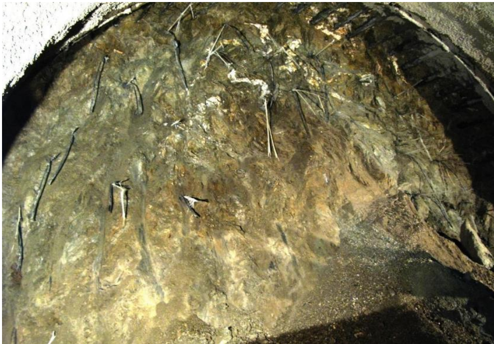
Εικόνα 40 Μετα – ιλυόλιθος Ανώτερου Αθηναϊκού Σχιστόλιθου σε μέτωπο εκσκαφής της Γραμμής 2 μεταξύ σταθμών «Άγιος Αντώνιος» και «Περιστέρι». (Boronkay et al., 2021)
