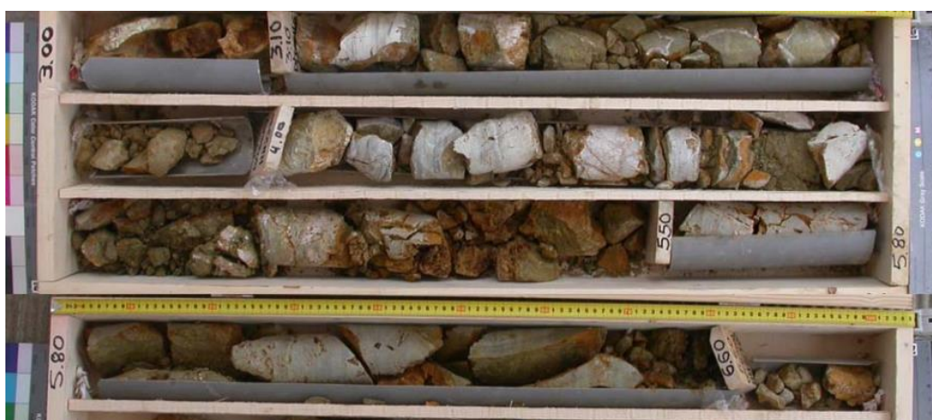
Εικόνα 86 Κατακερματισμένος – αποδιοργανωμένος ασβεστόλιθος με GSI: 30-40 (Γ:HH2230).
