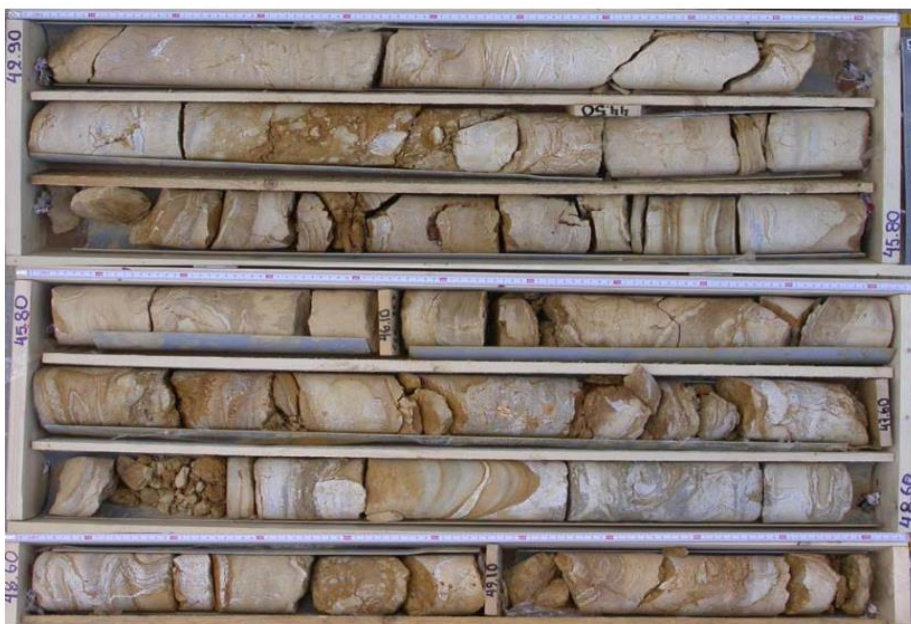
Εικόνα 46 Λεπτοστρωματώδης, πτυχωμένος, μαργαίικος ασβεστόλιθος (Ψαμμιτομαργαϊκή Σειρά). Γεώτρηση από υπό κατασκευή Γραμμή 4, ενδιάμεσα των σταθμών «Ελικώνος» και «Κυψέλη». (Boronkay et al., 2021)
