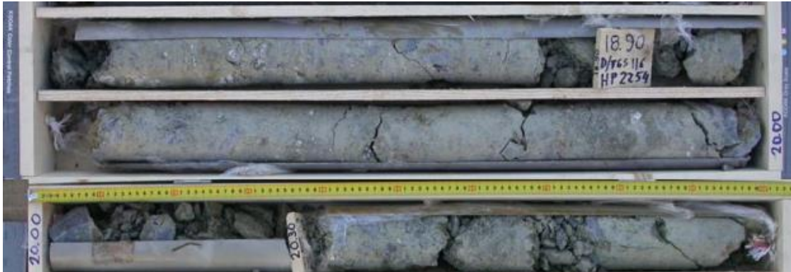
Εικόνα 89 Τεμαχώδης φαμμίτης με GSI: 55-65 (Γ:HP2254).
