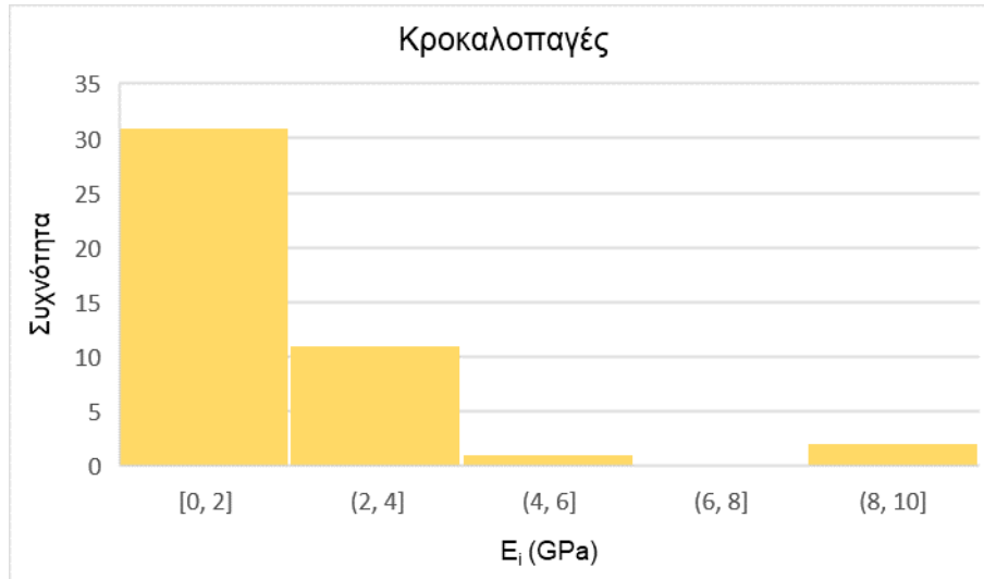
Εικόνα 69 Ιστόγραμμα μέτρου ελαστικότητας E_i κροκαλοπαγών.
