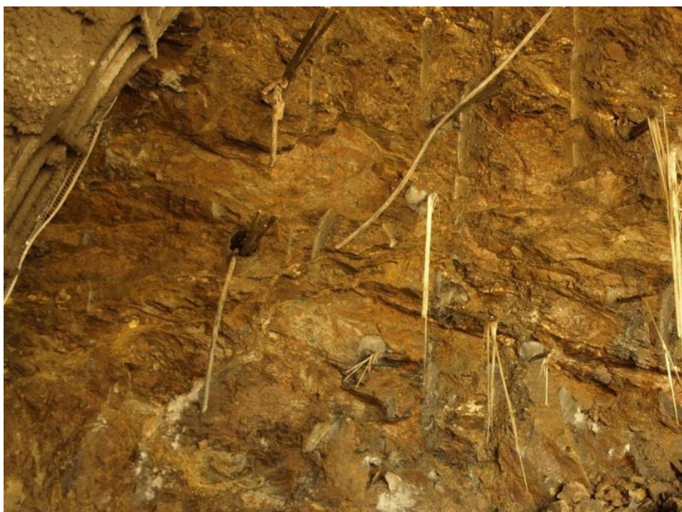
Εικόνα 41 Ελαφρά αποσθρωμένος μετα – ψαμμίτης Ανώτερου Αθηναϊκού Σχιστόλιθου σε μέτωπο εκσκαφής στον σταθμό «Περιστερί» της Γραμμής 2. (Boronkay et al., 2021)
