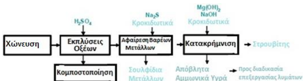
Σχήμα 4.26 – Διάγραμμα ροής της διαδικασίας Seaborne (Bayerle 2009)
