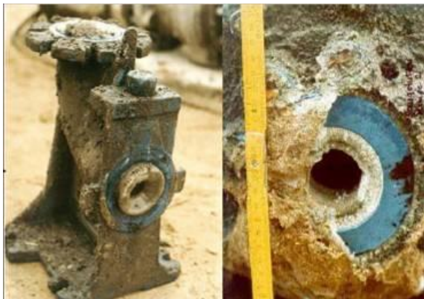
Σχήμα 4.5 – Αντλίες και σωλήνες εισαγωγής με καθιζήσεις στρουβίτη (Heinzmann 2009)
