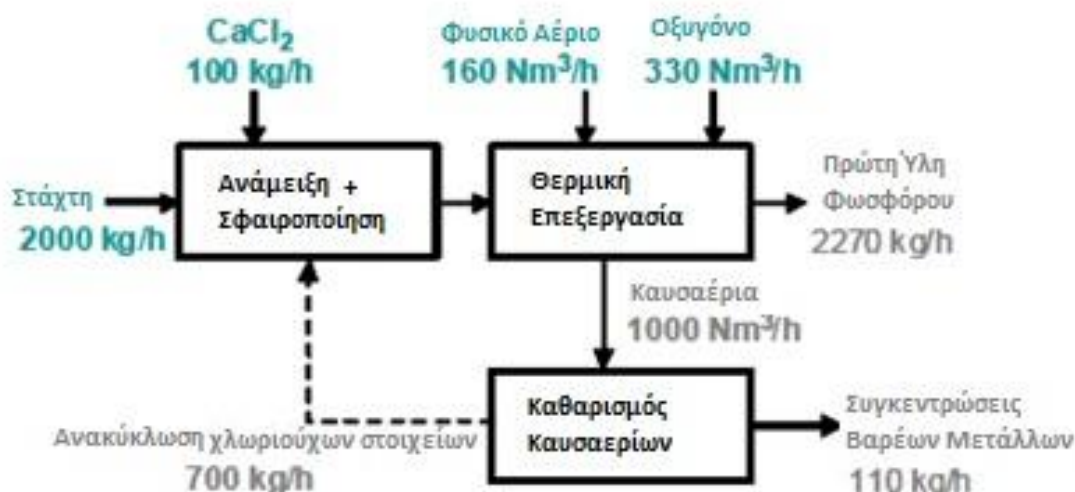
Σχήμα 5.11 – Η ροή το επεξεργαζόμενων υλικών στην μέθοδο ASH DEC (ASH DEC 2009)
