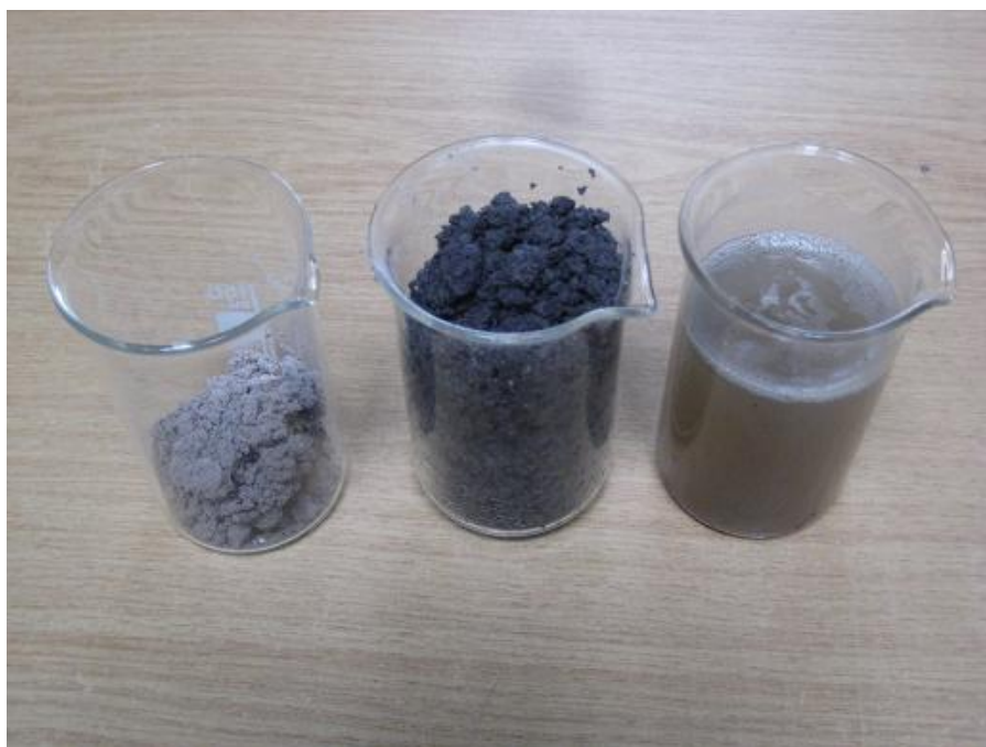
Σχήμα 4.28 – Άμορφος στρουβίτης που παράχθηκε μέσω της διαδικασίας Seaborne και έπειτα από ατμοσφαιρική αφυδάτωση (αριστερά) και διαχωρισμό μέσω φυγοκέντρησης (μεσαίο δείγμα). Στα δεξιά φαίνεται και η υγρή φάση που παράγεται κατά την φυγοκέντρηση
