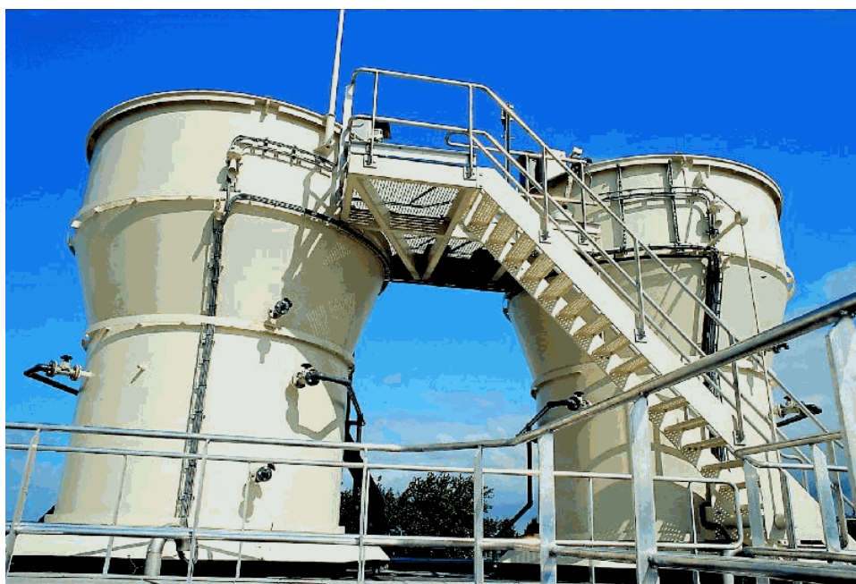
Σχήμα 4.4 – Δεξαμενές ανάκτησης φωσφόρου στην μονάδα επεξεργασίας αστικών λυμάτων στο Geestmerambacht της Ολλανδίας (Giesen, 2009)
