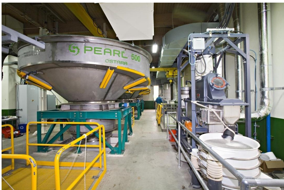
Σχήμα 4.17 – Φωτογραφία από την μονάδα επεξεργασίας λυμάτων και ανάκτησης φωσφόρου του Durham. Το τελικό προϊόν το οποίο προέρχεται από τον αφυγραντήρα είναι στο κάτω δεξιό μέρος της φωτογραφίας
