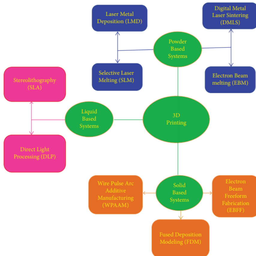
Σχήμα 1.6 Διάγραμμα τεχνικών τρισδιάστατης εκτύπωσης.[10]
