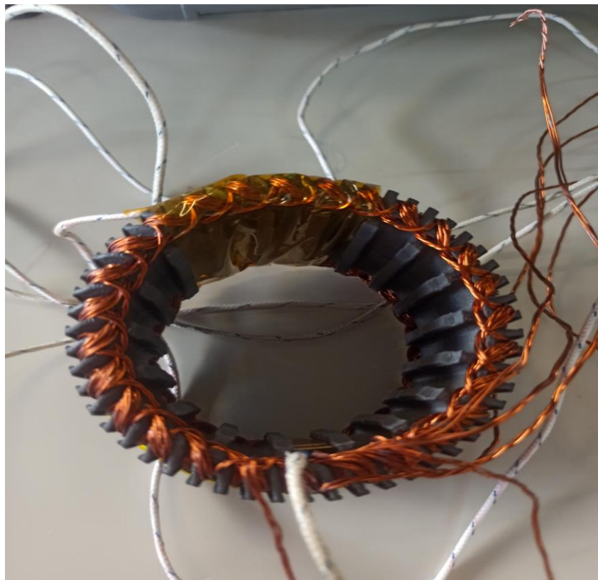
Σχήμα 4.3 Λεπτομέρεια κάτοψης του στάτη.
