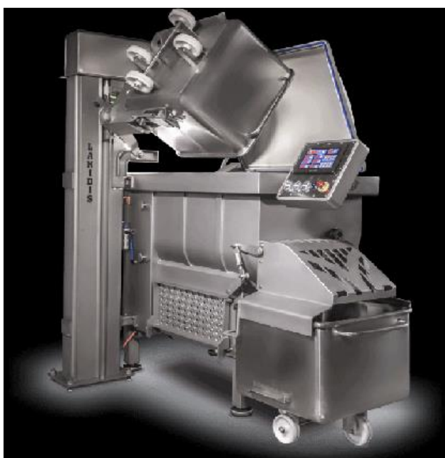
Εικόνα 2.3 Παράδειγμα μηχανής ανάδευσης με “κουπιά” Μηχανή ανάδευσης (αριστερά) Κουπιά (paddles) (δεξιά) Ιδιοκτησία της LAKIDIS SA FOOD MACHINERY, Ελλάδα
