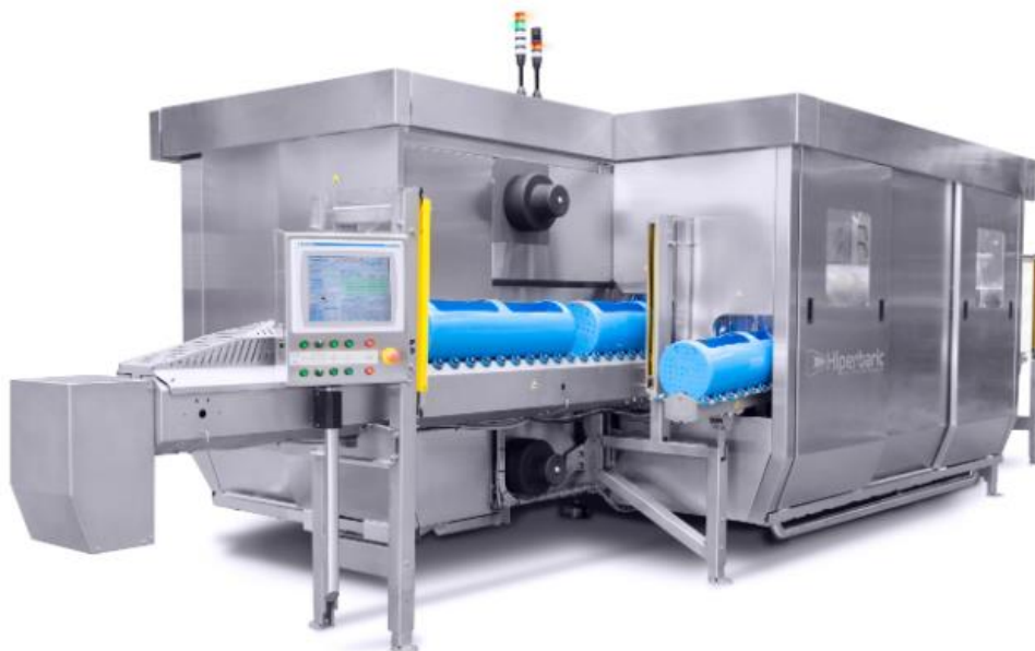
Εικόνα 3.1 Διάγραμμα ροής της HPP και μονάδα HPP Ιδιοκτησία της Hiperbaric SA, Ισπανία
