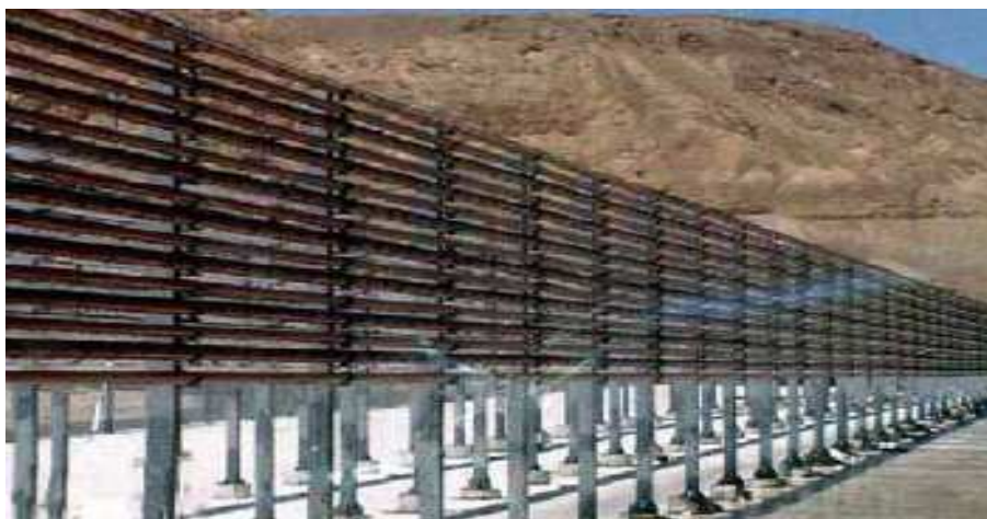
Εικόνα 3.5: Παραγωγή του είδους Haemotococcus pluvialis σε σωληνοειδείς φωτοβιοαντιδραστήρες . Κάθε σωλήνας έχει μήκος 100m και διάμετρο 5 cm. (Algatel Co., Israel) Προέλευση: T. J. Lundquist, 2007 μετά από προσαρμογή.
