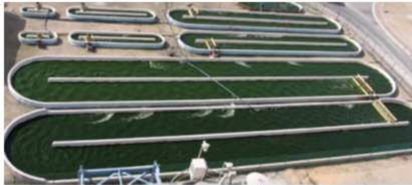
Εικόνα 3.11: Τεχνητές λίμνες ελισσόμενου στίβου. Προέλευση: Drapcho & Bruna, 2006.
