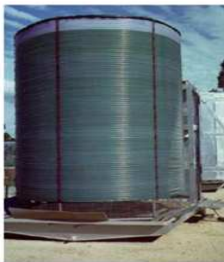
Εικόνα 3.2: Φωτό-βιοαντιδραστήρας υπό την μορφή πηνίου χωρητικότητας 1000 λίτρων (Murdoch University, Australia) Πηγή: T. J. Lundquist, 2007
