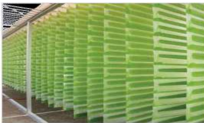
Εικόνα 3.3: Αντιδραστήρες Κάθετης Στήλης. Προέλευση: T. J. Lundquist, 2007 μετά από προσαρμογή.
