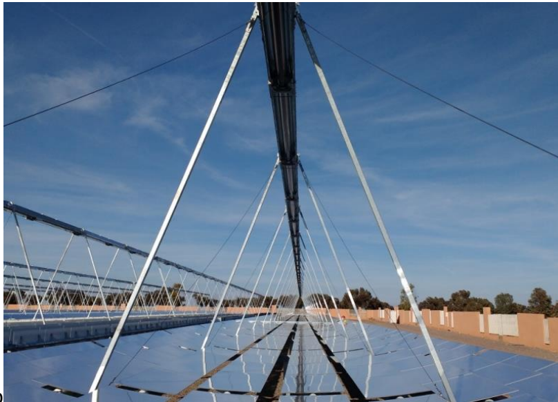
Εικόνα 3.1: Επιμήκης ηλιακός συλλέκτης Fresnel της εταιρείας Soltigua [69].
