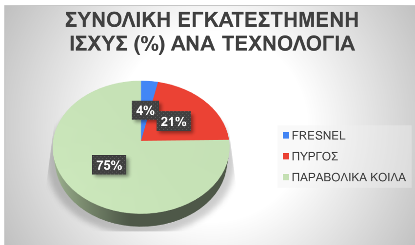
Σχήμα 5.3: Συνολική εγκατεστημένη ισχύς ανα τεχνολογία σε MW (α) και ποσοστιαία (β). Πρόκειται για σταθμούς σε λειτουργία ή εν αναμονή λειτουργίας (υπό κατασκευή).
