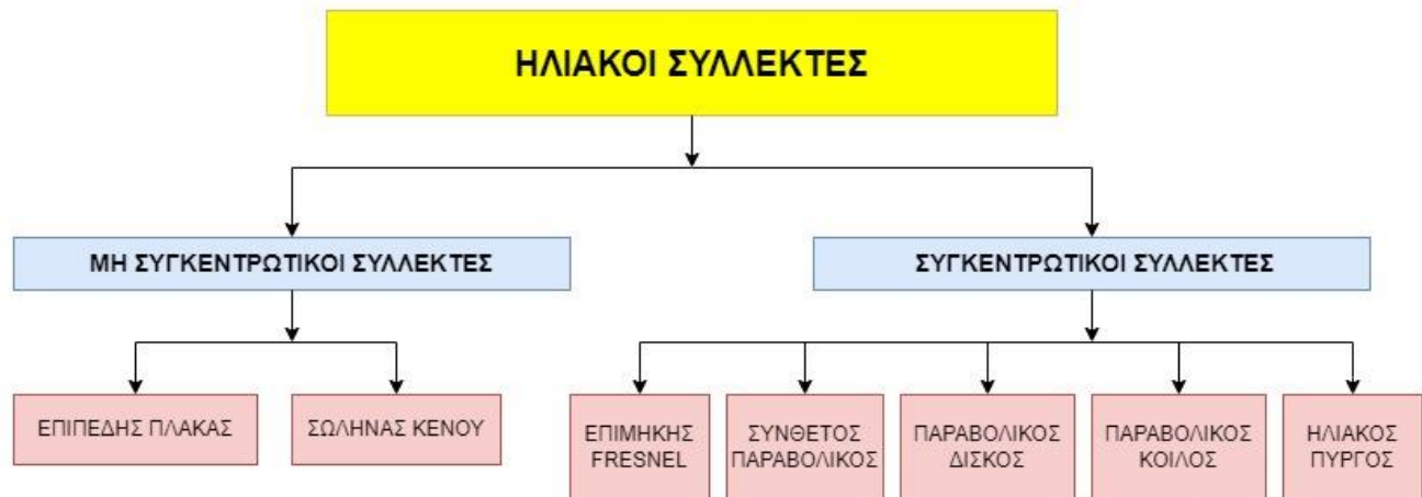
Σχήμα 3.1 : Ταξινόμηση και κατηγορίες ηλιακών συλλεκτών.
