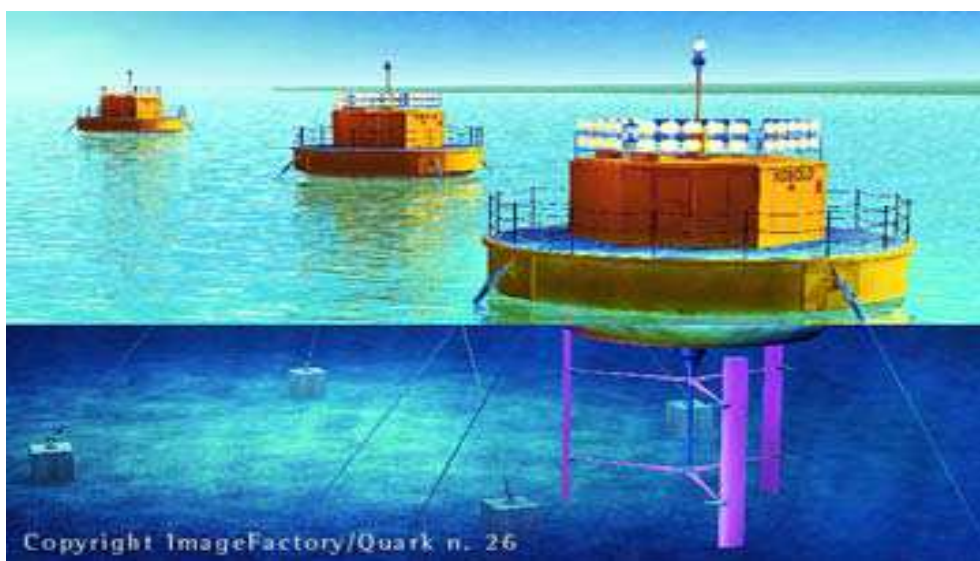
Εικόνα 3.2.4: Σύστημα κατακόρυφου άξονα (Enermar) ( www.eusustel.be )
