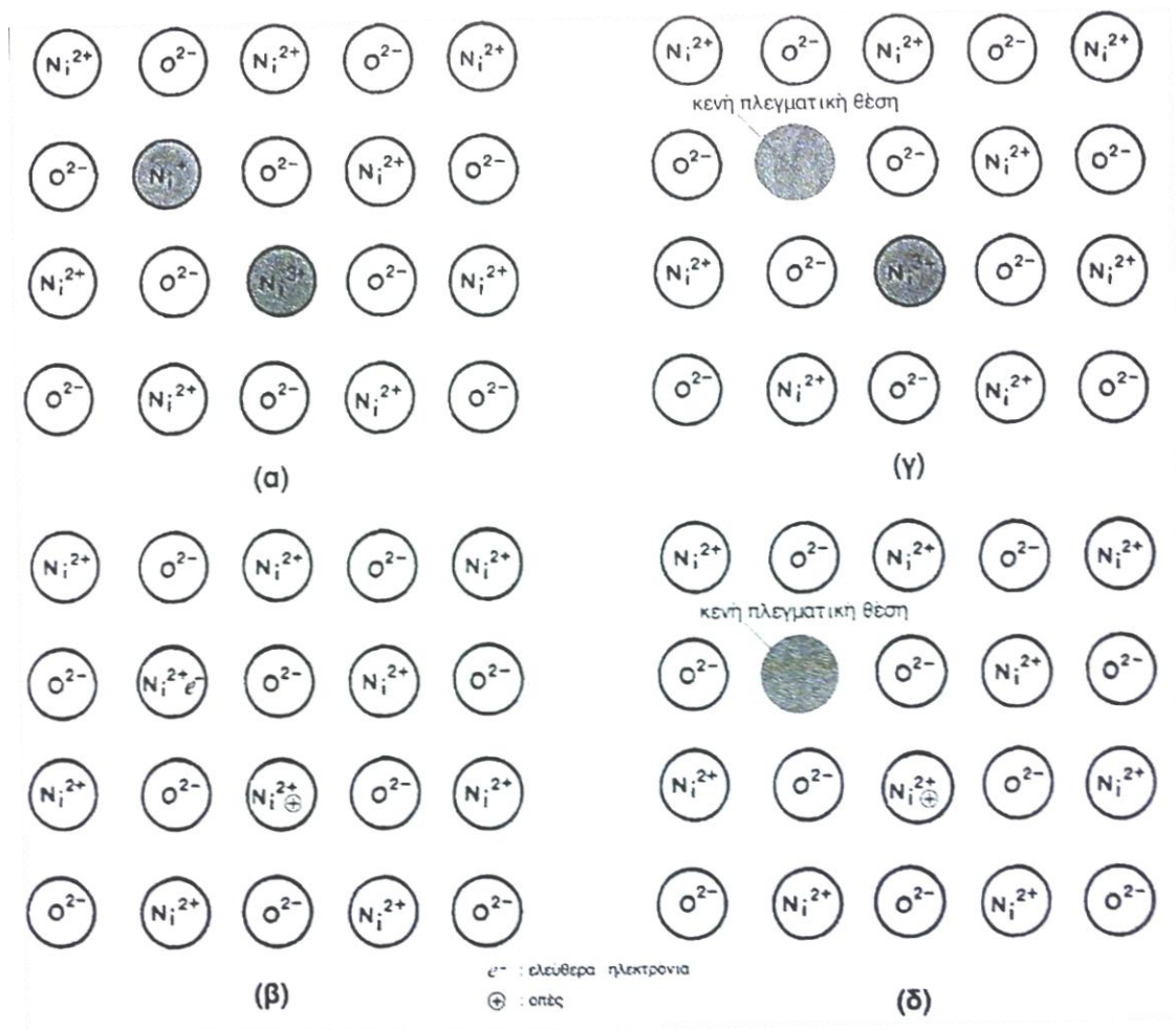
Σχήμα 2.5 Η ενδογενής (α,β) και εξωγενής (γ,δ) ημιαγωγιμότητα στο NiO [8].
