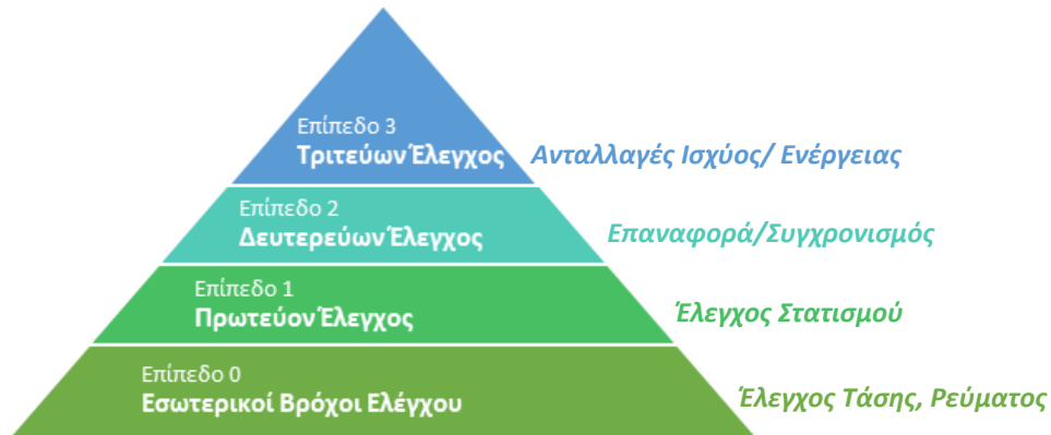
Σχήμα 14: Ιεραρχία επιπέδων ελέγχου ενός μικροδικτύου με ικανότητα σύνδεσης/αποσύνδεσης από το δίκτυο.
