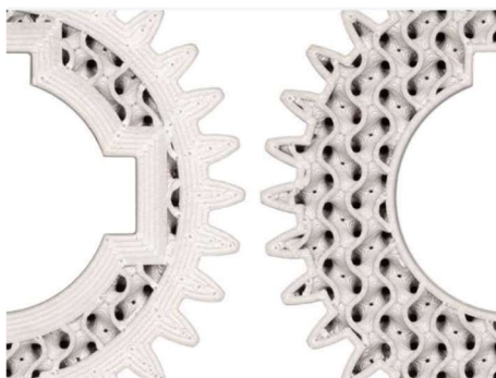
Εικόνα 19: Οδοντωτοί τροχοί τυπωμένοι με διαφορετικό πάχος τοιχώματος και gyroid infill.
