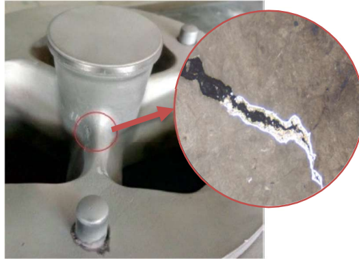
Εικόνα 9: Μάκρο-ρωγμές στον πόδα της μήτρας.
