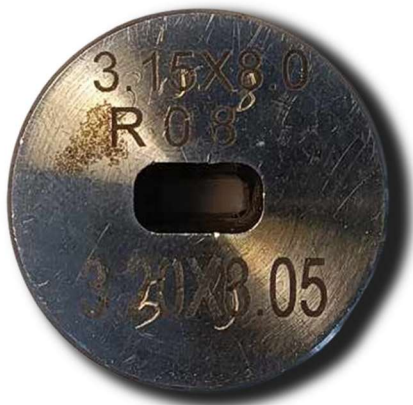
Εικόνα 26: Διαστάσεις οπής μήτρας: 3.15x8.0
