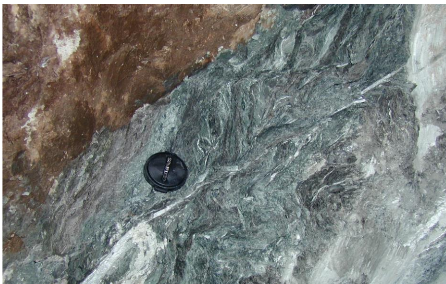
Εικόνα 6.5 Χαρακτηριστική εμφάνιση τεκτονικά διατμημένου ιλυολίθου με χαστική δομή στη σήραγγα Ανθοχωρίου. (Πηγή: ΤΙΑΣ, Μαρίνος et al., 2006; Μαρίνος Β., 2007; Marinos et al., 2010).
