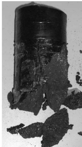
Σχήμα 5.52 Το δοκίμιο του πειράματος A17d κατόπιν της ερπυστικής αστοχίας για επιβαλλόμενη ένταση t/t_f=0.46 (Debernardi, 2008).
