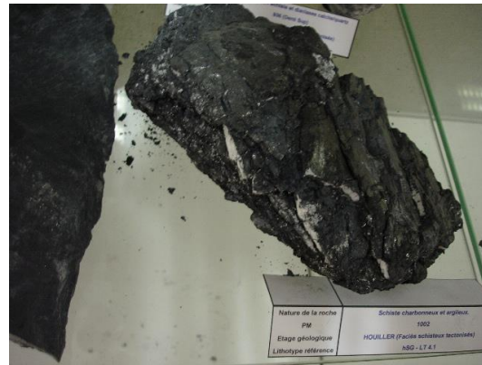
Εικόνα 5.5 Γραφικός σχιστόλιθος του λιθανρακοφόρου, ο οποίος απαντήθηκε κατά τη διάνοιξη της σήραγγας πρόσβασης Saint Martin La Porte στη σήραγγα βάσης Lyon - Turin.
