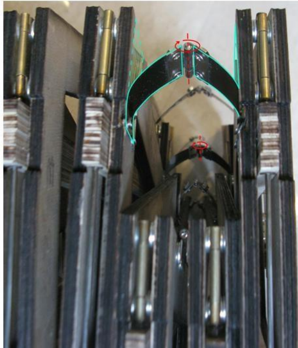
Σχήμα 4.6: Ο σύνδεσμος κάμψης και περιστροφής (flexural hinge joint) σε διάγραμμα και σε φυσικό μοντέλο
