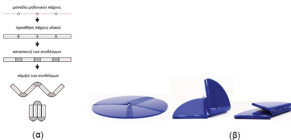
Σχήμα 3.42: (α) Διάγραμμα της Μεθόδου Συνδέσμων SORCE, (β) Πρόπλασμα της Μεθόδου Συνδέσμων SORCE, Πηγή: (Lang et al., 2018)
