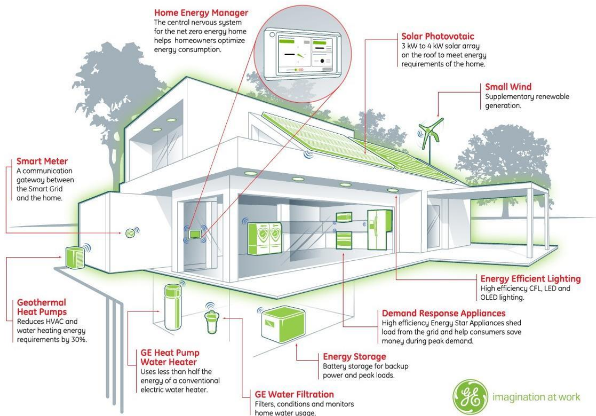
Σχήμα 2.26 Σχηματική αναπαράσταση λειτουργίας BEMS σε κτίριο κατοικίας[62]
