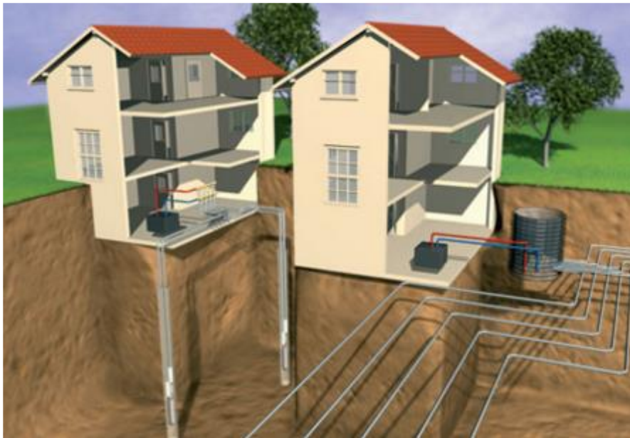
Σχήμα 2.25 Σχηματική αναπαράσταση συστήματος οριζόντιων και κατακόρυφων γεωεναλλακτών [60]
