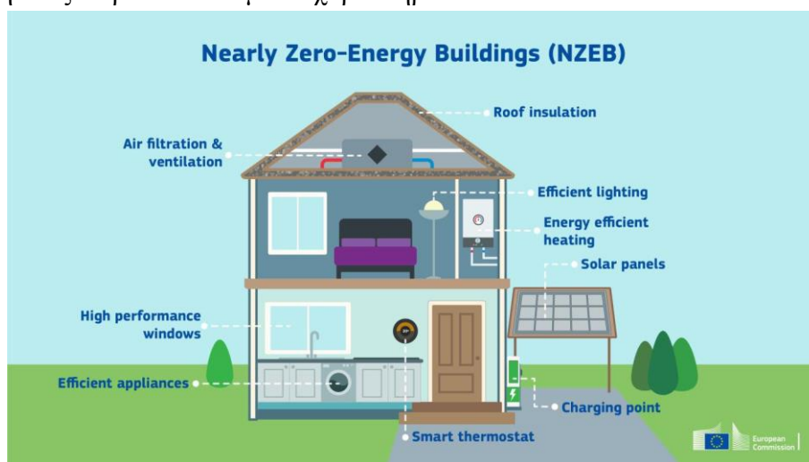
Σχήμα 2.5 Σχηματική απεικόνιση κτιρίου nZEB [19].
