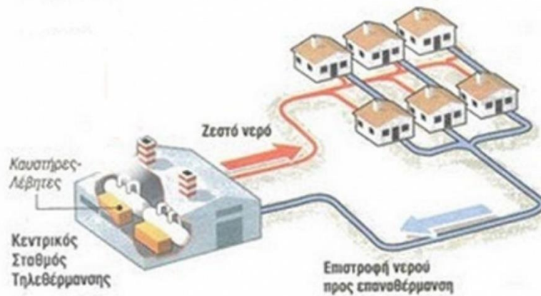
Σχήμα 2.24 Σχηματική αναπαράσταση συστήματος τηλεθέρμανσης[59].
