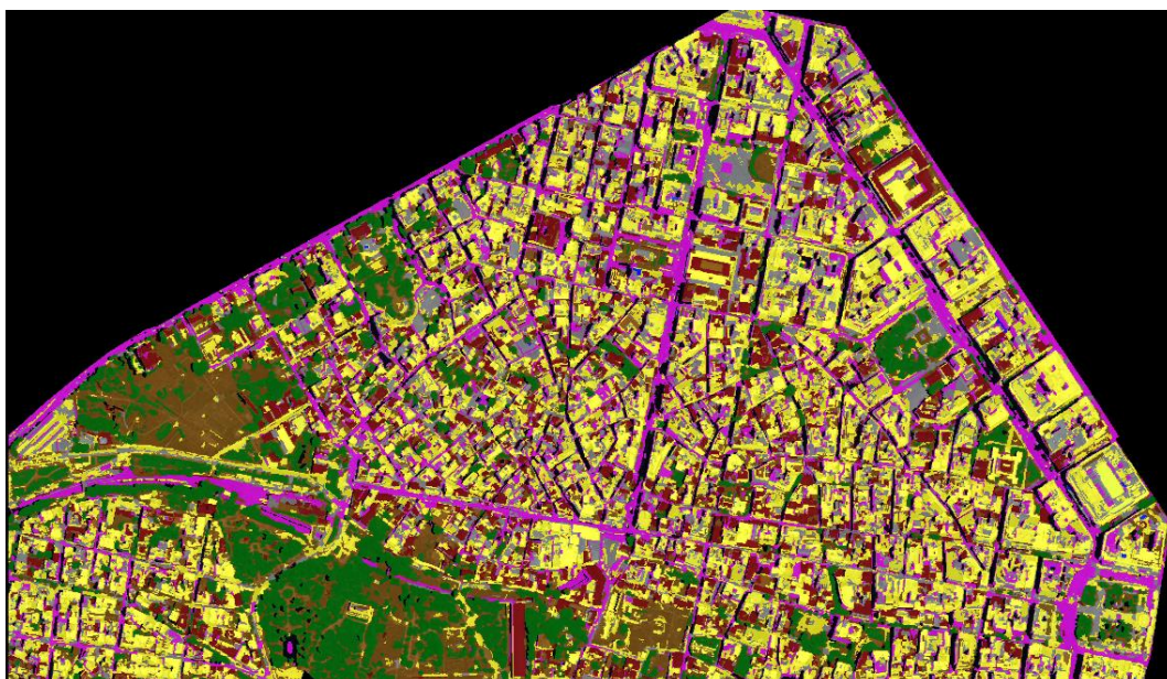
Εικόνα 59: Το αποτέλεσμα της ταξινόμησης με χρήση του αλγόριθμου Random Forest για την περιοχή Εμπορικό Τρίγωνο – Θεσείο (Πηγή: ίδια επεξεργασία).
