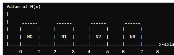
Εικόνα 18: B-splines μηδενικής τάξης. Ο x άξονας αναπαριστά τις τιμές 0 με 4 και ο y άξονας αναπαριστά την τιμή της B-spline συνάρτησης. Κάθε B-spline μοιάζει με κουτί κι έχει ύψος 1 μεταξύ των ορίων του, ενώ γίνεται 0 έξω από αυτά.
